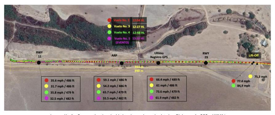
Imagen No. 2 – Comparativo de velocidades alcanzadas en la pista Los Ripios según GPS – HK2021
