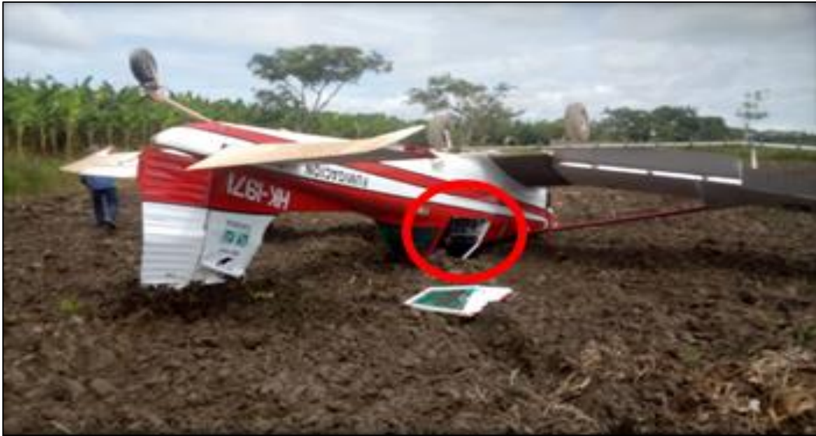
Fotografía No. 4 – Ventana y punto de evacuación.
