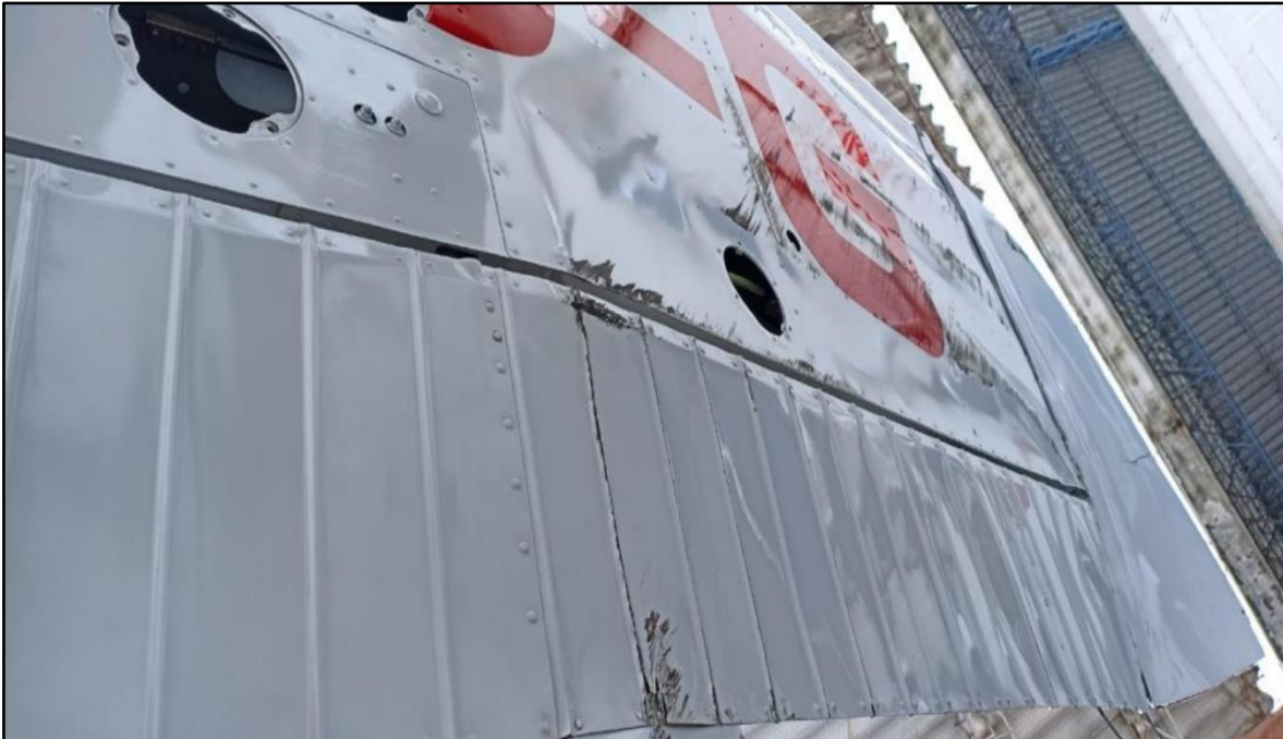
Fotografía 4. Desprendimiento de pintura y hundimientos en plano izquierdo, zona inferior, estaciones 144 a 208.
