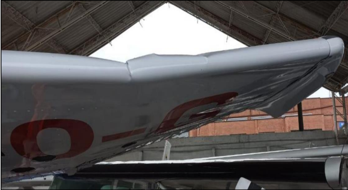
Fotografía 1. Deformación en el plano izquierdo, entre las estaciones 144 a 208, con deformación visible con ángulo positivo, hundimiento y corrugación en la piel en borde de ataque.
