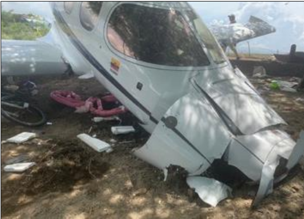
Fotografía No. 4 – Daños parte delantera fuselaje (sector CAPS Y radomo).
