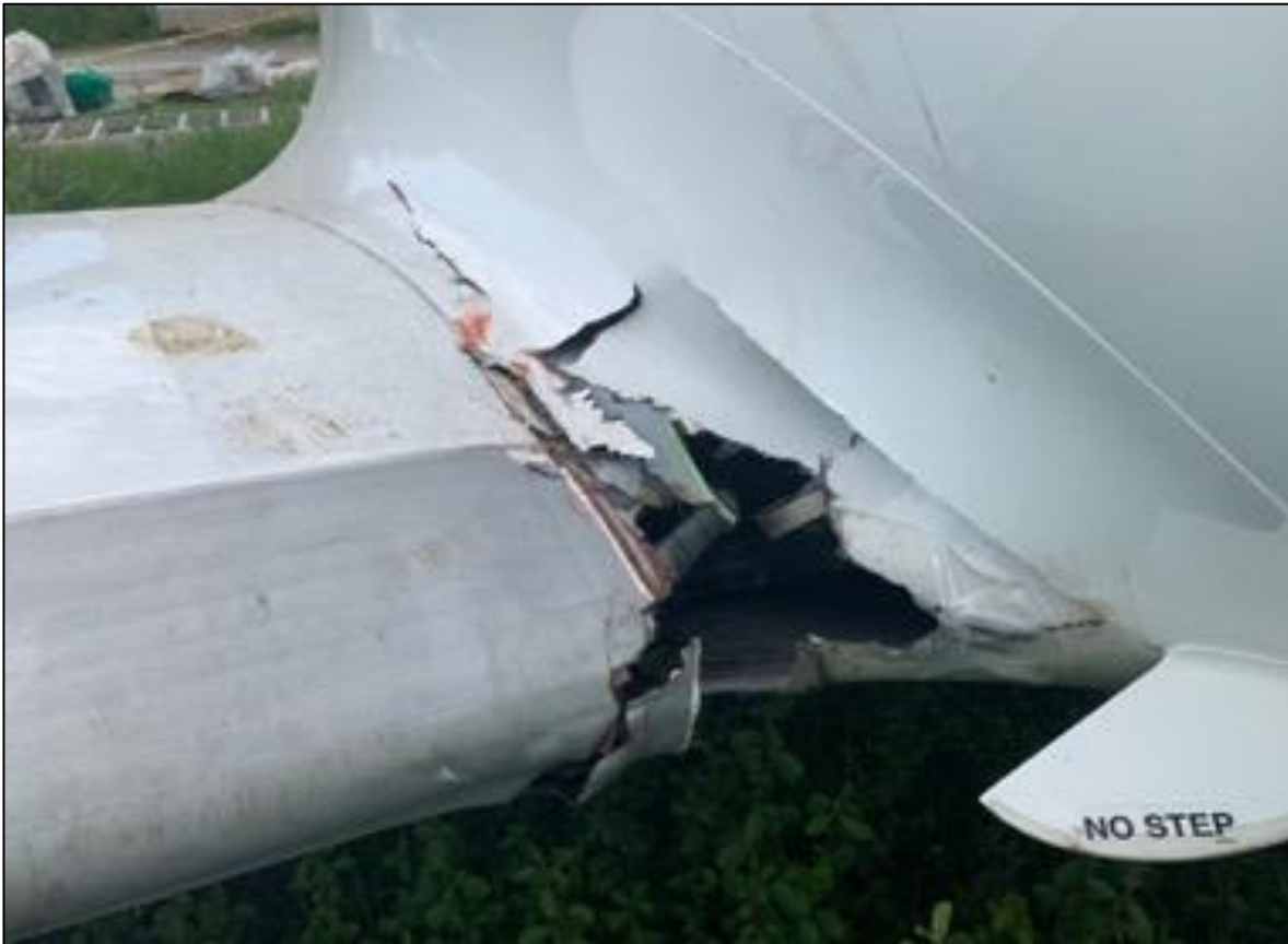
Fotografía No. 5 – Daños borde de ataque plano izquierdo.
