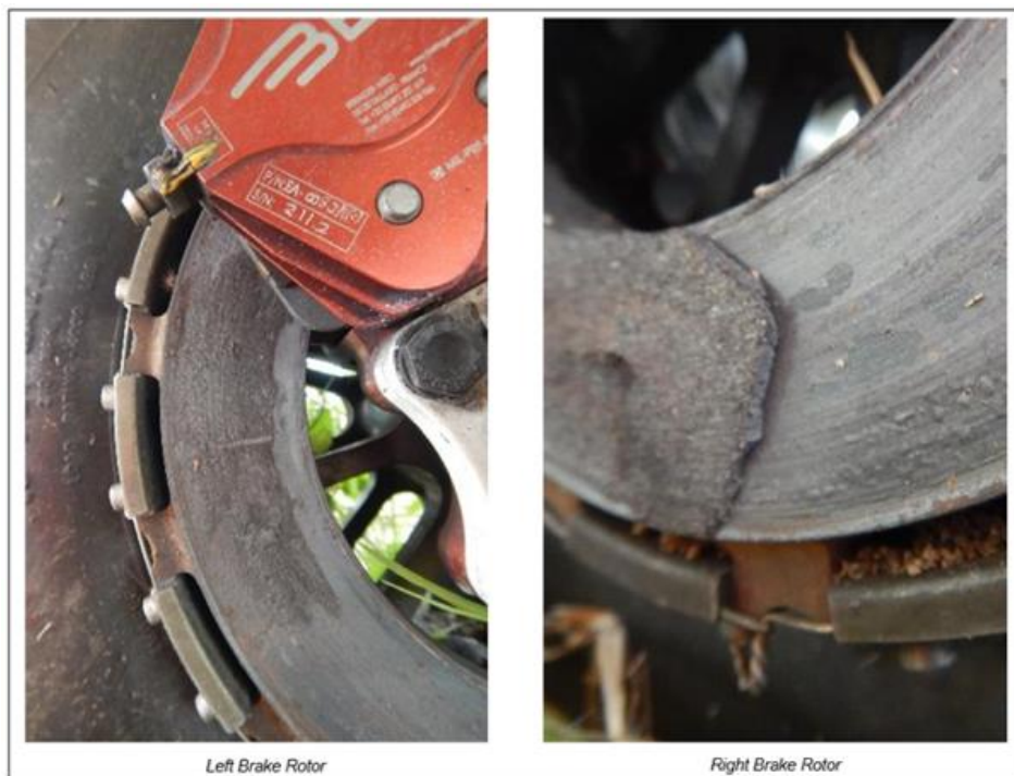
Fotografía No. 9 – Material de las pastillas de los frenos soldado por alta temperatura.
