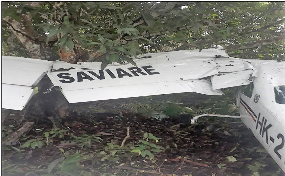
Fotografía No. 3 – Desprendimiento del plano izquierdo de la aeronave.
