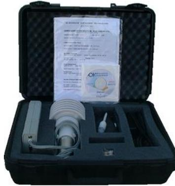
**Ilustración 24. Equipo de calibración de flujo DeltaCal**
