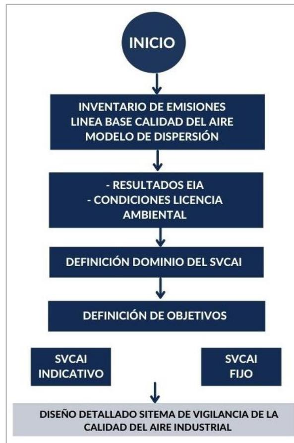
**Ilustración 2. Diagrama de flujo para el diseño SVCAI para actividades industriales**
