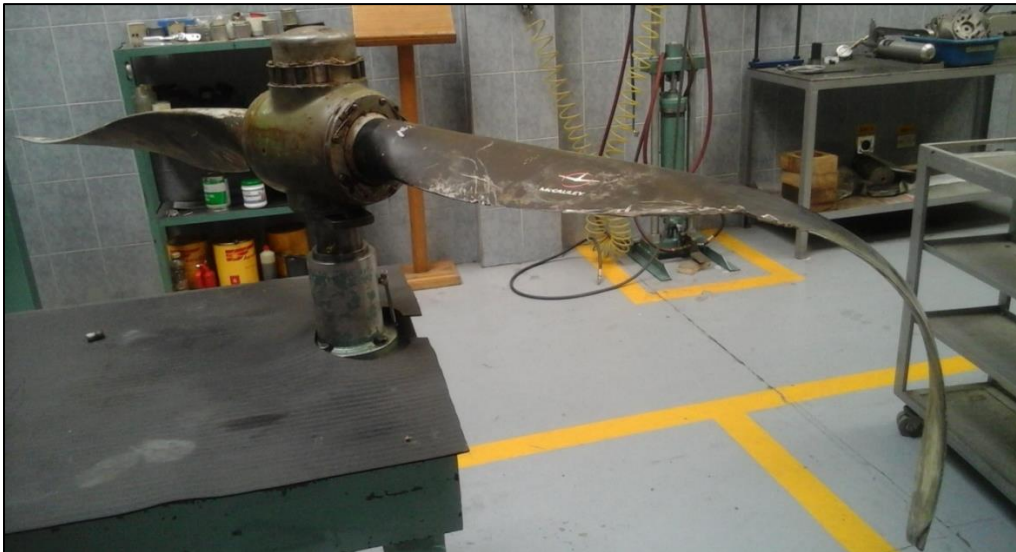
Fotografía No .5: Inspección post-accidente a la hélice McCauley D2134C98-0
