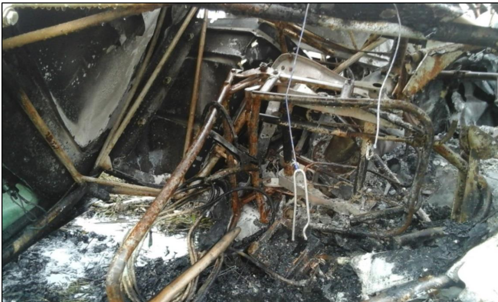
Fotografía No. 3: Condición de la cabina de vuelo y silla del Piloto afectada por el fuego
