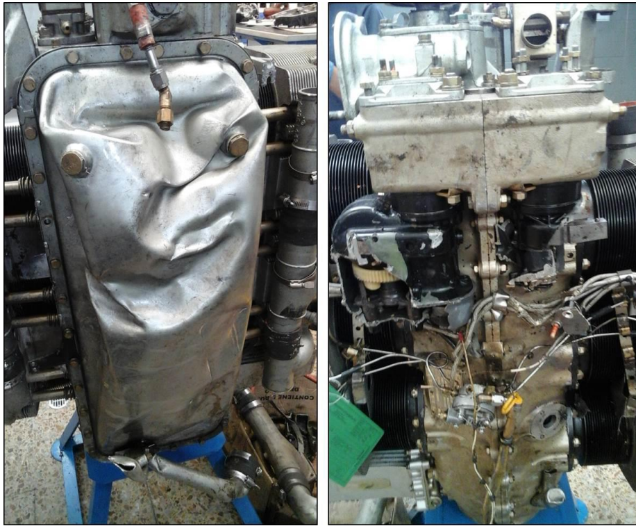
Fotografía No. 4: Inspección post-accidente al motor Continental IO-520D S/N501121
