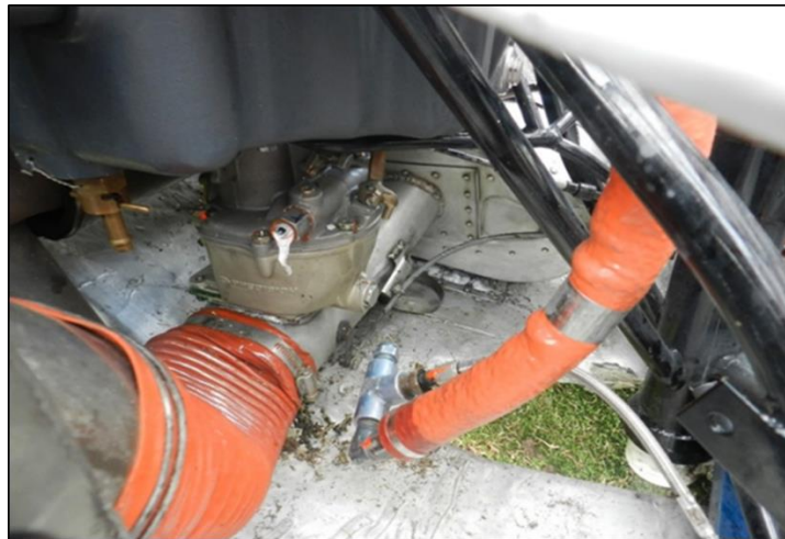
Fotografía No. 8: Evidencia de desconexión de la manguera de combustible al carburador.
