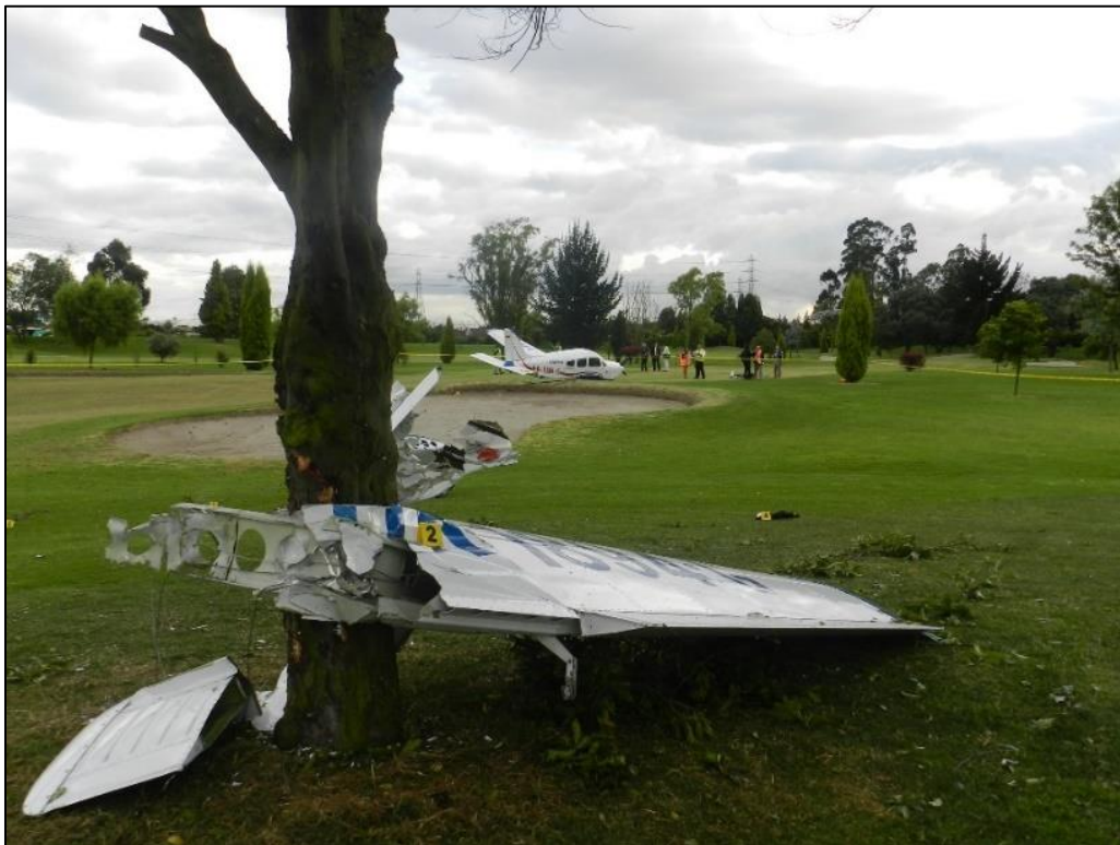
Fotografía No. 3: Destrucción del plano derecho por el golpe contra árbol
