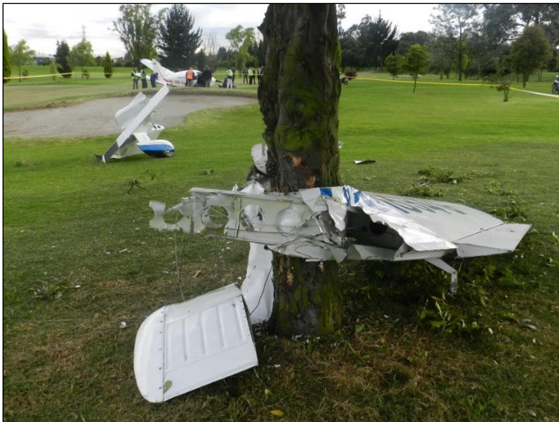
Fotografía No. 4: Detalle de la destrucción del plano derecho por el golpe contra árbol
