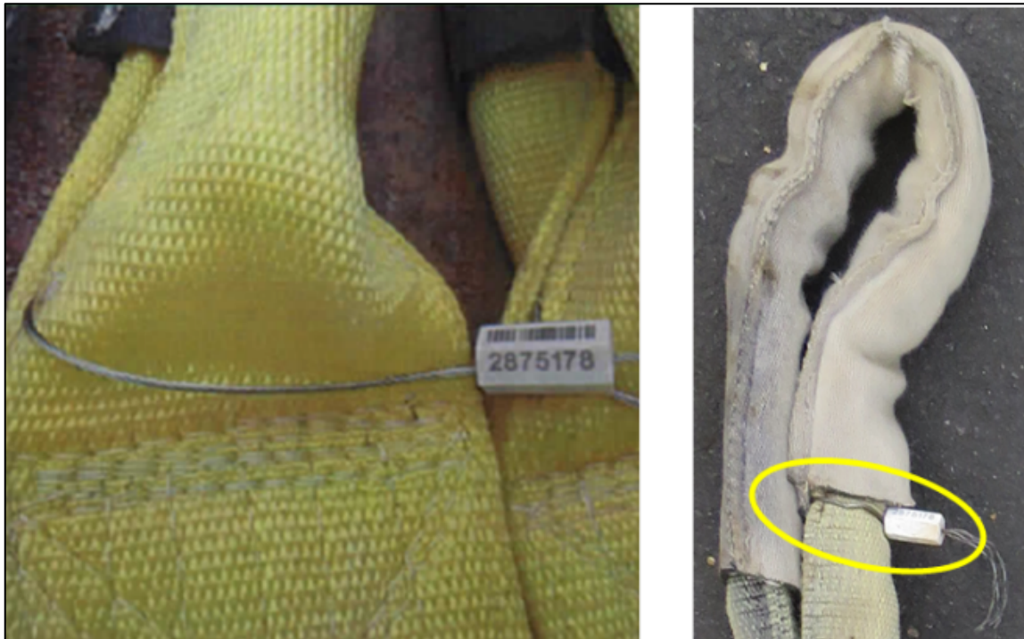
Imagen No. 8 – Localización del precinto en los ojos de la eslinga. La imagen en la derecha muestra la localización del precinto instalado en la eslinga del ramal derecho.
