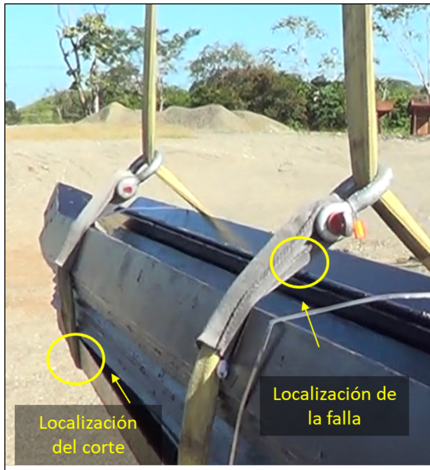
Imagen No. 9 – Localización de la interacción con la eslinga y la carga de ángulos acero.
