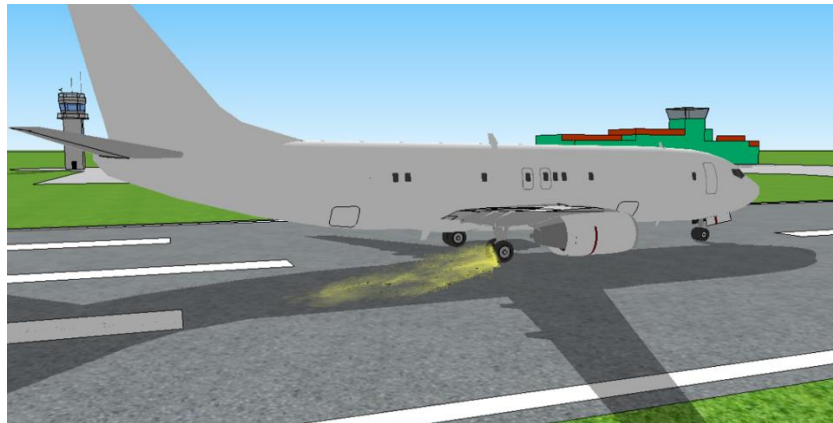
Recreación de la explosión de la rueda No 4 de la aeronave HK 5197
