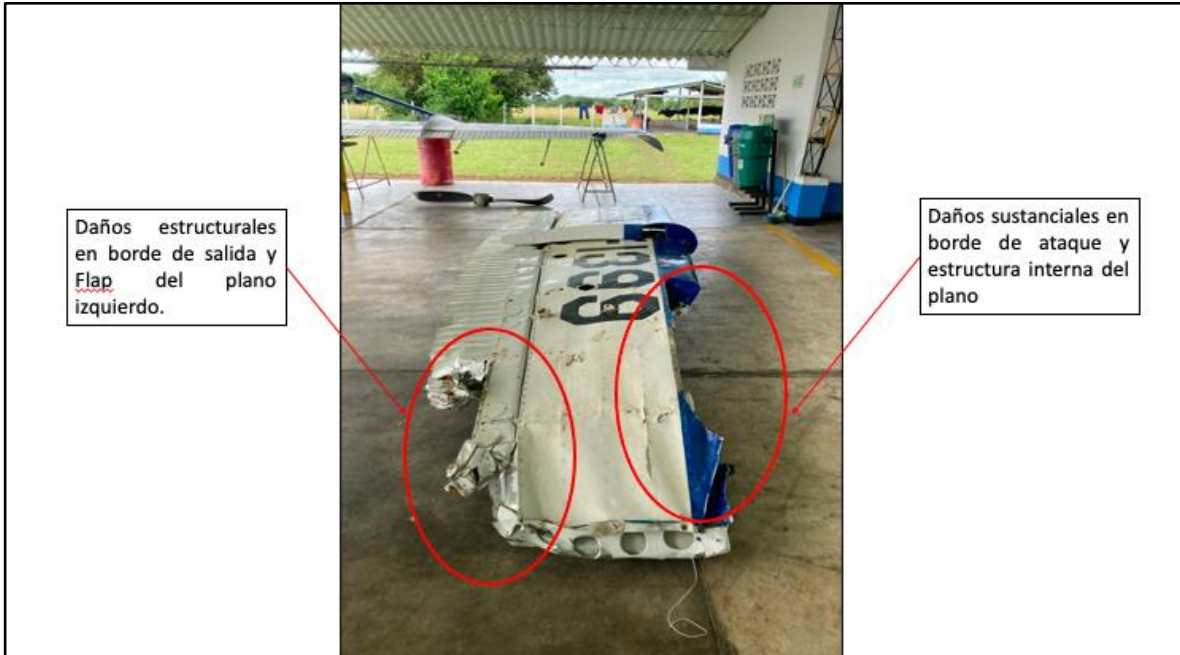
Fotografía No. 1 - Concentración de daños plano izquierdo HK-1399
