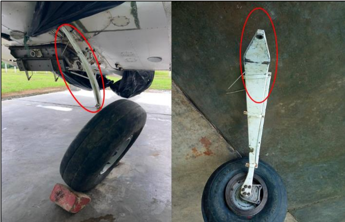
Fotografía No. 3 - Daños estructurales en la zona 700, tren de aterrizaje izquierdo.
