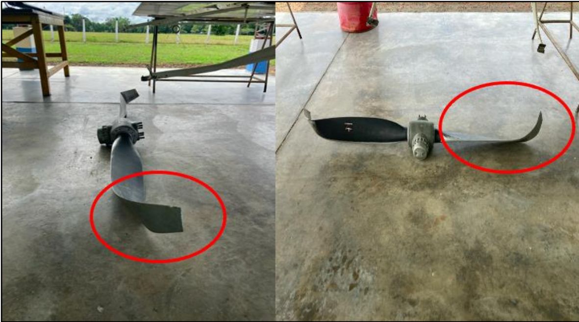
Fotografía No. 2 - Deformación de la hélice motor HK-1399
