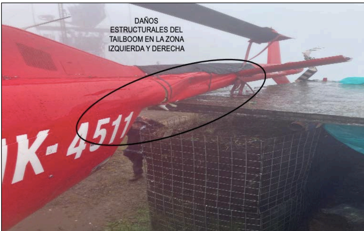
Fotografía No. 2: Daños estructurales tailboom HK-4511.
