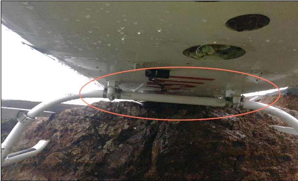
Fotografía No. 1: Daños en la parte ventral HK-4511.
