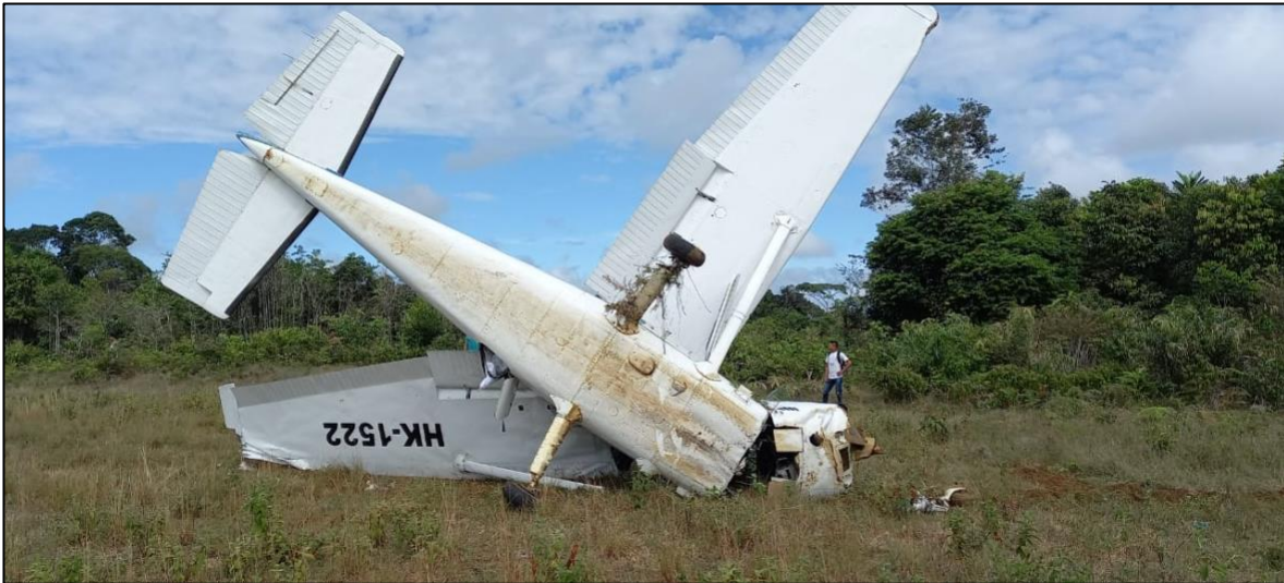
Fotografía No. 4 - Daños sufridos por la aeronave y vegetación enredada en el tren de aterrizaje.
