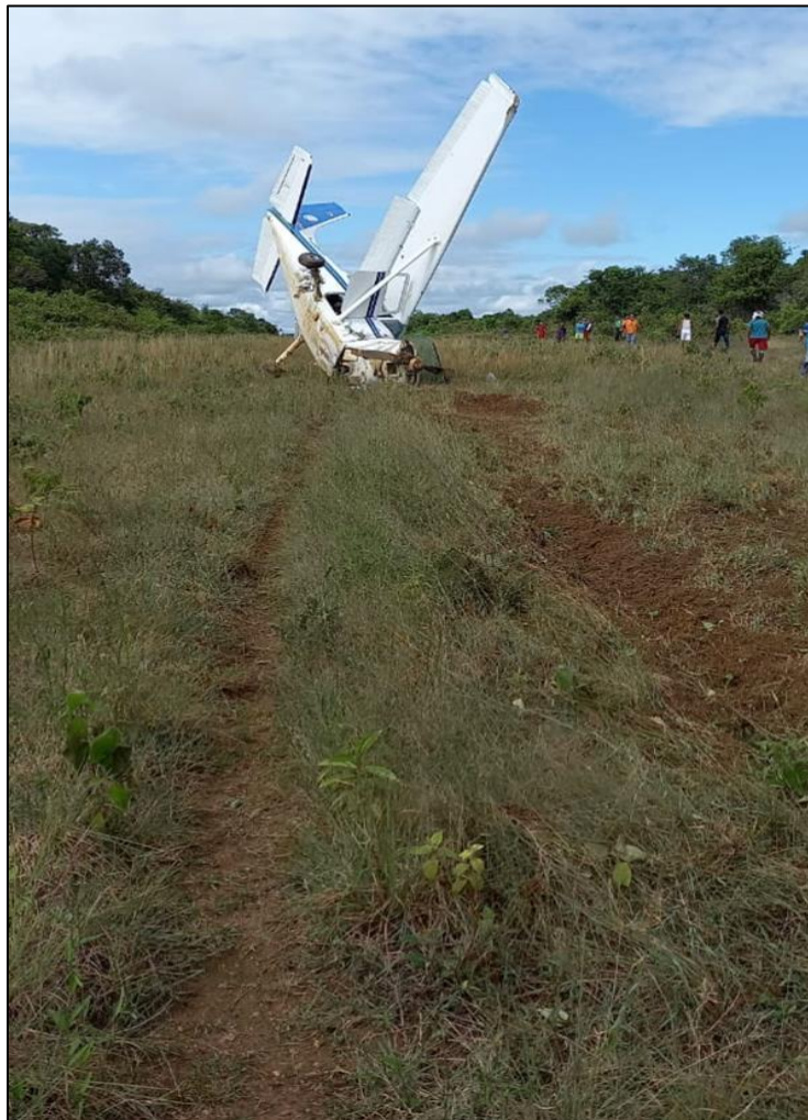
Fotografía No. 3 - Huellas dejada por el tren de aterrizaje sobre el terreno.
