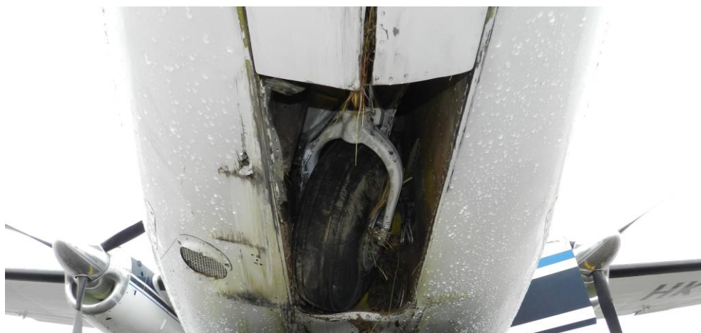
Daños en la sección ventral y tren de nariz aeronave HK1771G
