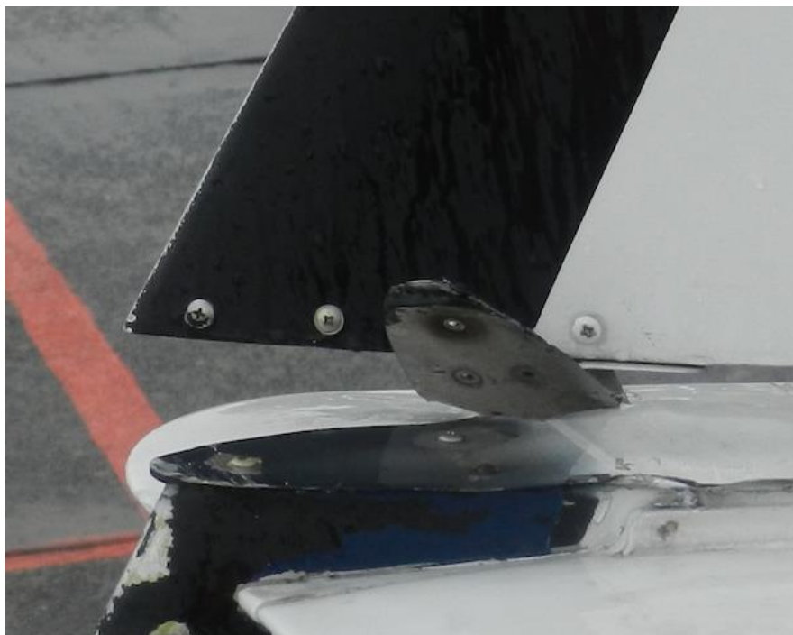
Condición general de la lámina cobertora ANTI-ICER RUDDER HORN P/N: 5E1487-2
