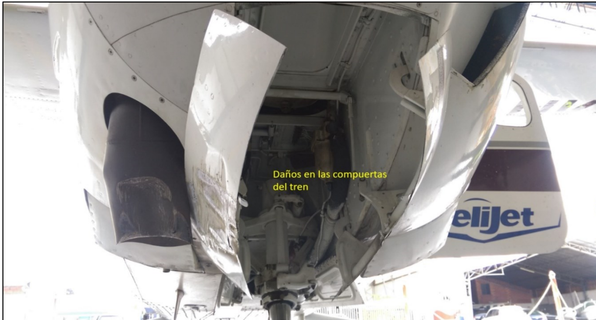
Fotografía No. 1: Daños en las compuertas de tren de nariz
