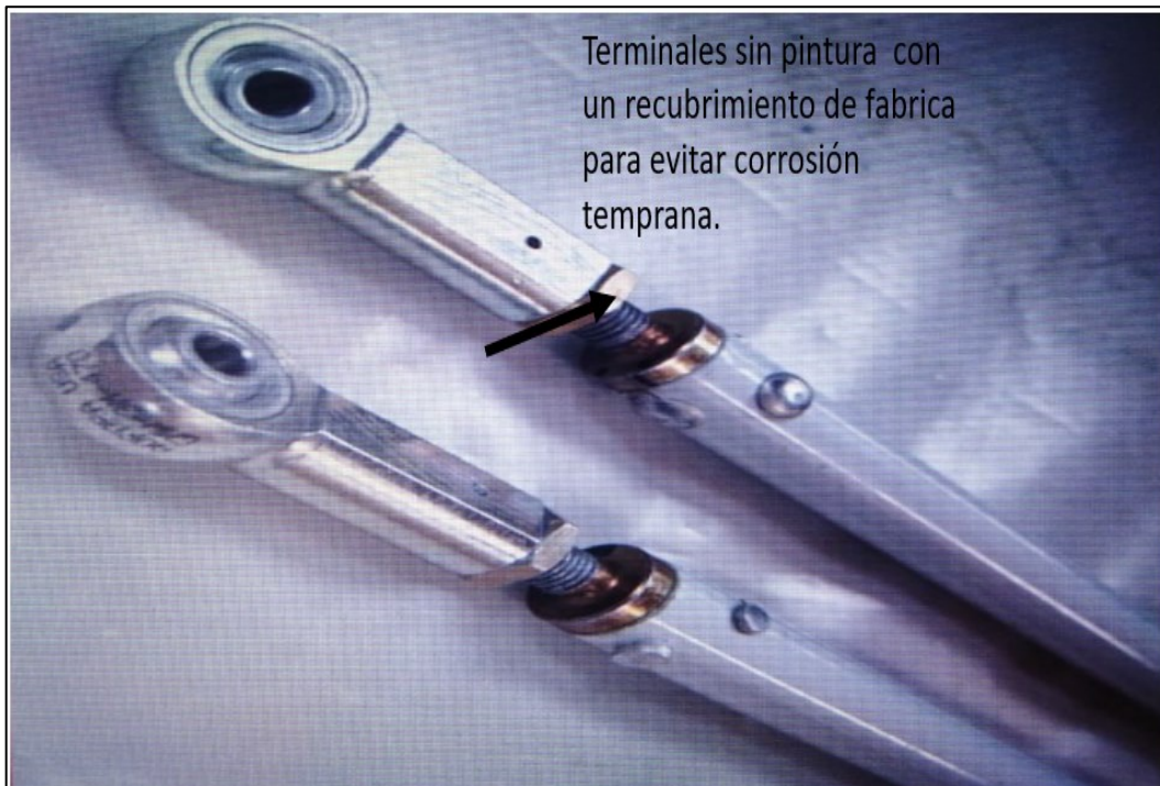
Fotografía No. 6: Condiciones ideales para la instalación de este tipo de tubos de extensión y retracción
