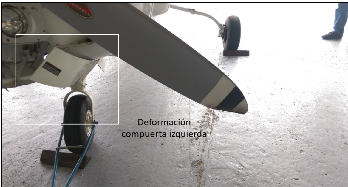
Fotografía No. 2: Deformación de la compuerta izquierda del tren de nariz.
