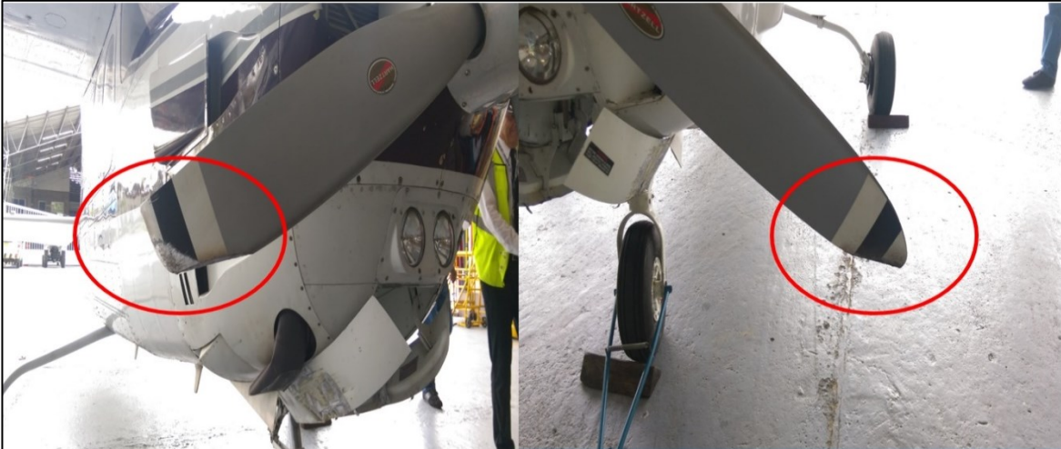
Fotografía No. 3: Pérdida de material en las puntas de la hélice (daños menores)
