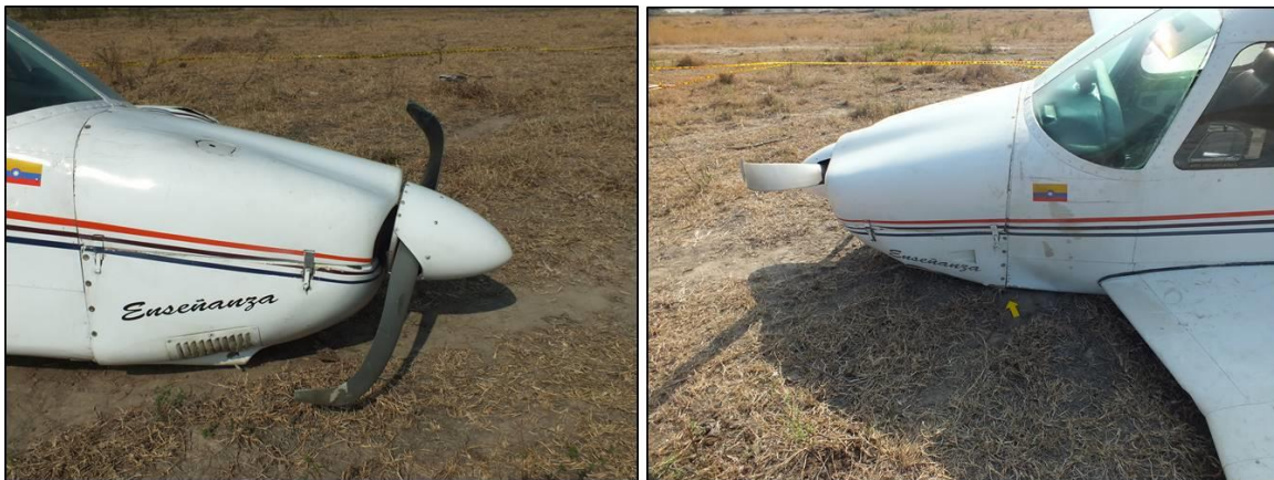
Daños sufridos en la hélice, paneles del motor y parabrisas frontal izquierdo
