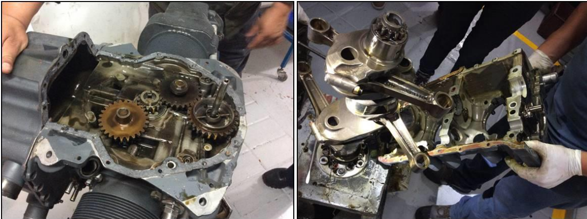
Desarmado e inspección de los componentes del motor
