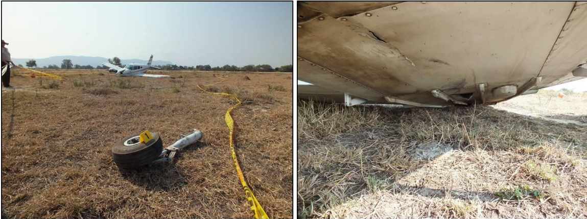
Desprendimiento del tren de aterrizaje izquierdo (Izq.) y daños en la zona inferior del fuselaje (Der.)
