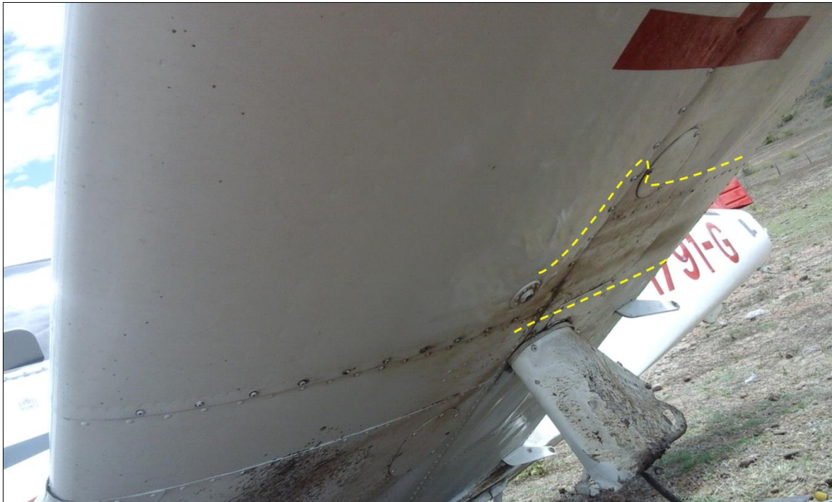
Fotografía No. 4: Probable evidencia de fuga de combustible en la zona inferior del plano
