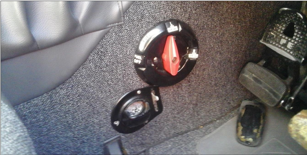
Fotografía No. 3: Condición de la válvula selectora de combustible en el sitio del Incidente Grave
