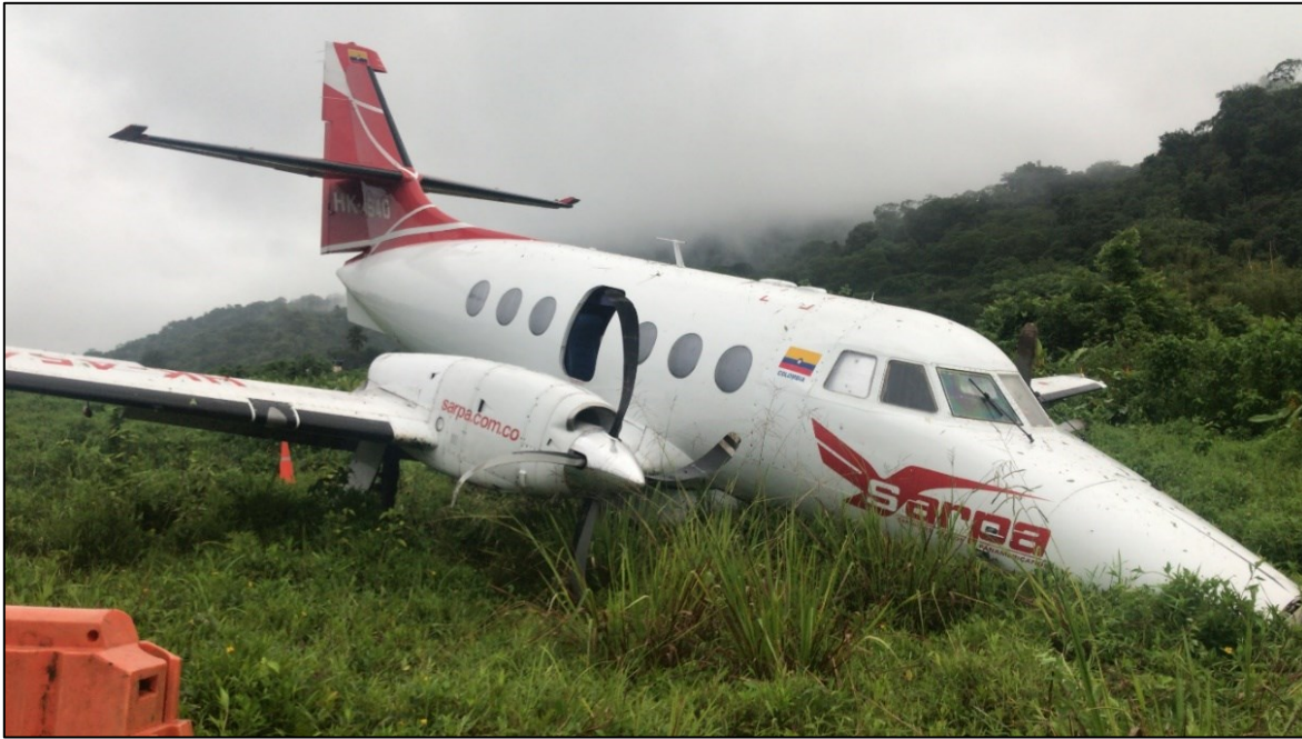
Imagen No. 2: Detalle de la zona de seguridad y daños en la hélice derecha
