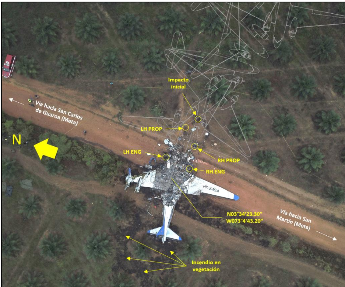
Imagen No. 2 – Escena del accidente y ubicación de sus componentes principales La marca de agua de la aeronave describe la dinámica más probable de impacto contra el terreno
