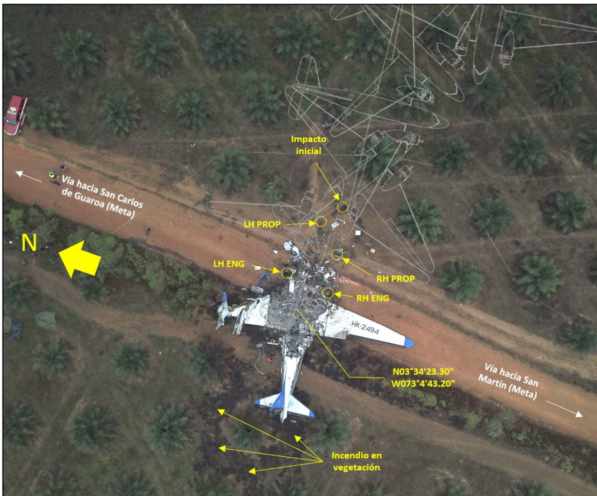
Imagen No. 3 – Escena del accidente y ubicación de sus componentes principales. La marca de agua de la aeronave describe la dinámica más probable de impacto contra el terreno
