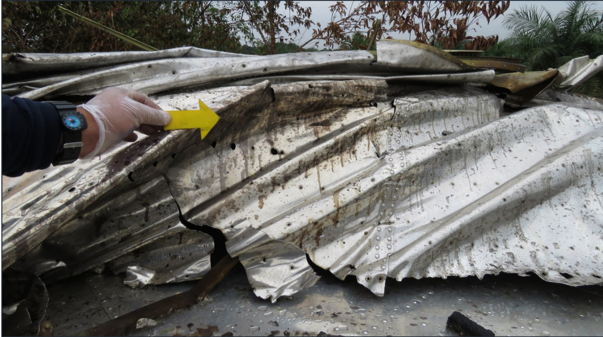
Fotografía No. 2 – Presencia de aceite en la sección del borde de ataque y extradós restos HK2494
