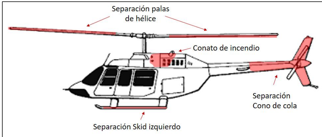
Figura No. 1 - Localización general de daños en el helicóptero HK3312
