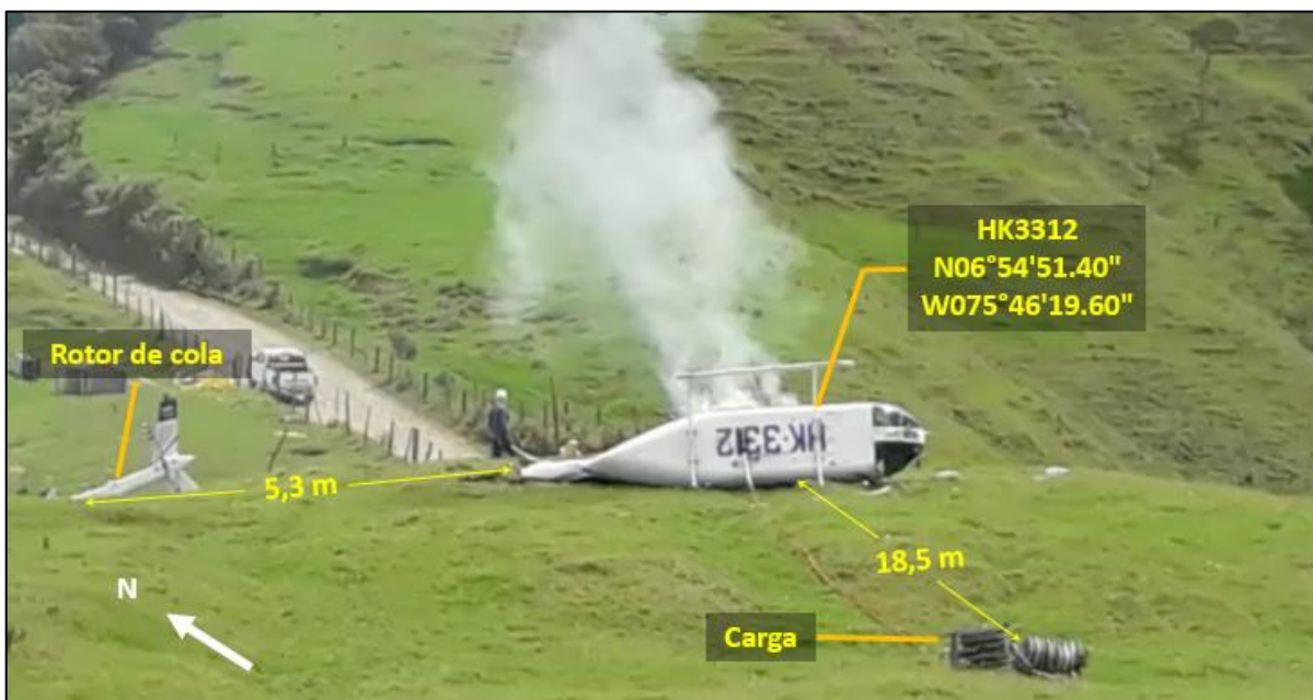
Fotografía No. 2 - Condición final helicóptero HK3312 y ubicación de evidencias en el sitio del accidente
