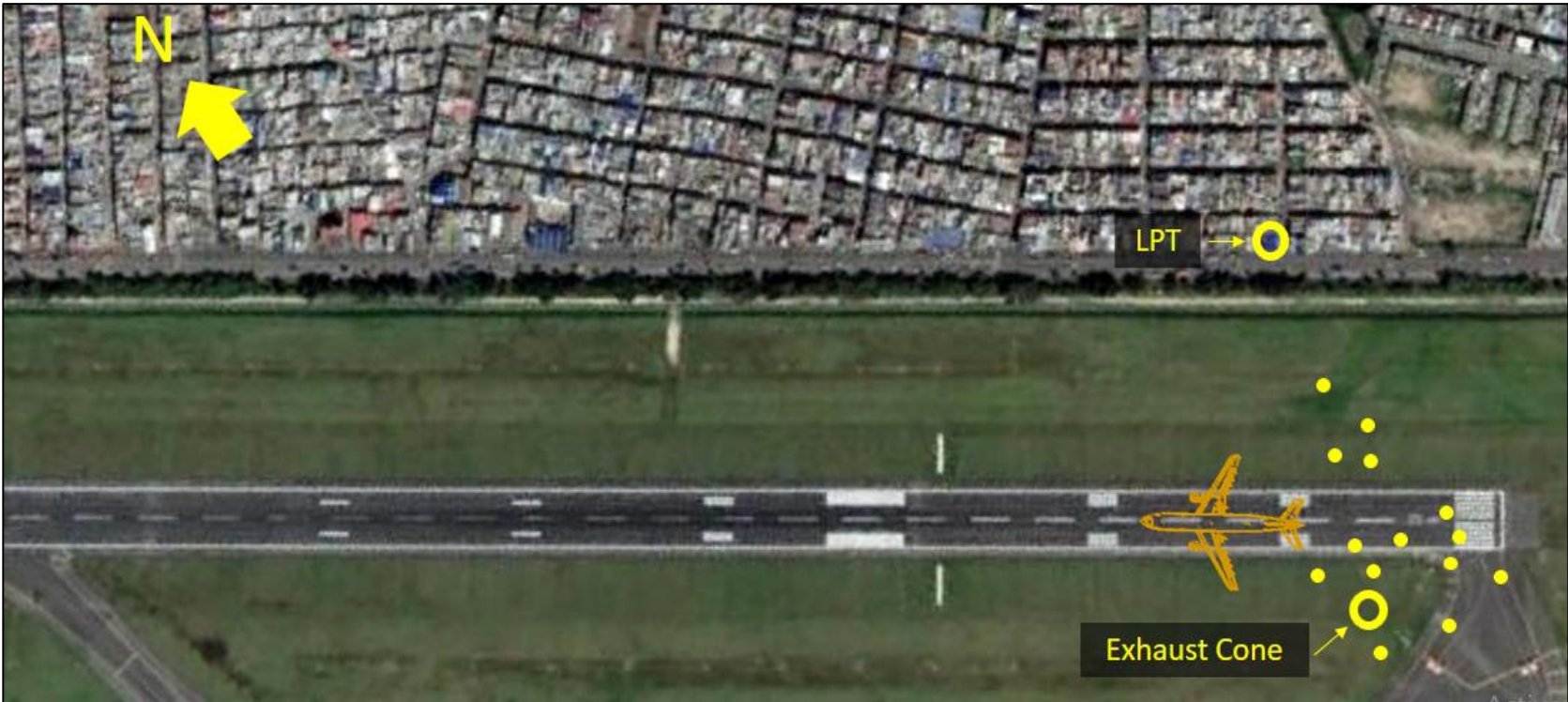
Figura No. 1: Distribución de restos y partes desprendidas del motor izquierdo, aeronave Airbus A300 – YV560T
