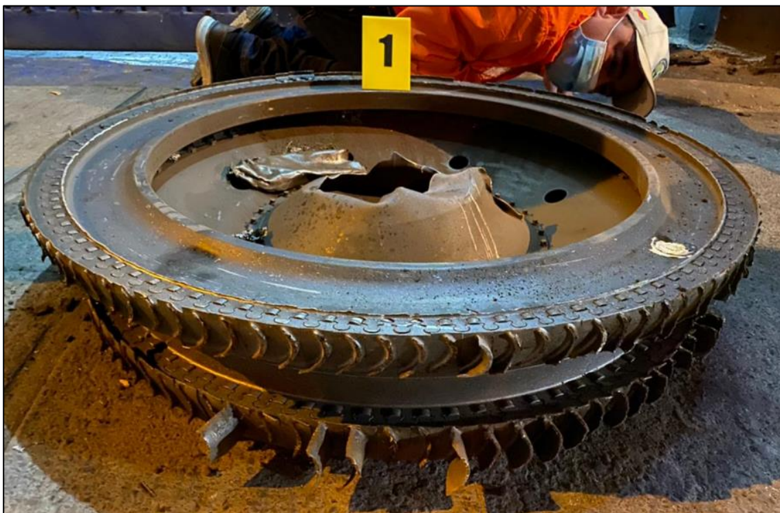
Fotografía No. 1: Sección Low Pressure Turbine (LPT) etapas No. 3 y No. 4
