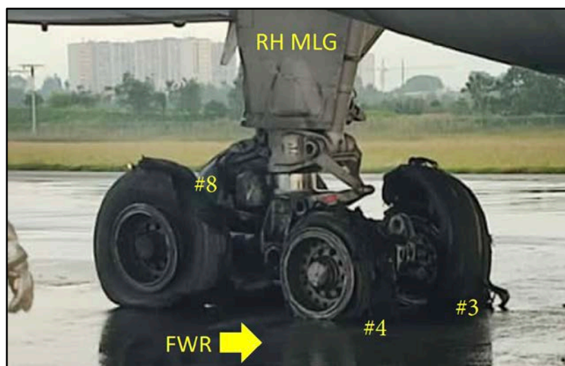
Fotografía No. 6 – Estado final del tren derecho YV560T
