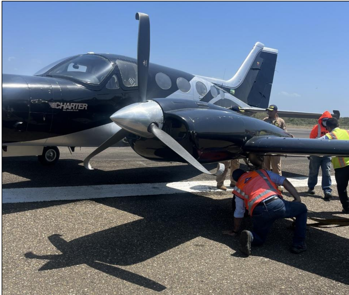
Fotografía No. 1 - Condición de la aeronave HK4837, una vez que se extendió el tren de aterrizaje principal izquierdo para su retiro de la pista.
