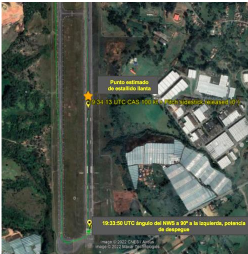
Imagen No. 5 – Carrera de despegue y posición de estallido de llanta
