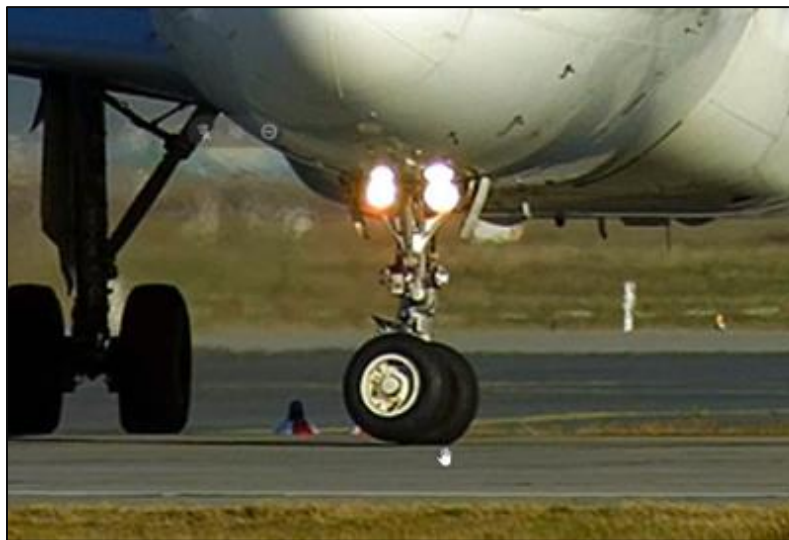
Fotografía No. 2 – Geometría de contacto de las ruedas cuando el NLG se gira a 90° - Fuente: Airbus.
