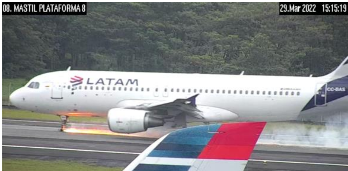
Fotografía No. 7 – Fotograma de deslizamiento y abrasión de la estructura del tren de nariz, aeronave CC-BAS.
