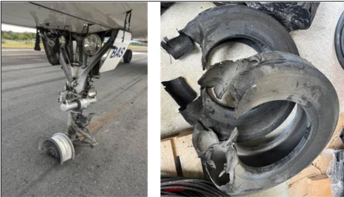
Fotografía No. 1 – Condición final del tren de nariz y ruedas CC-BAS
