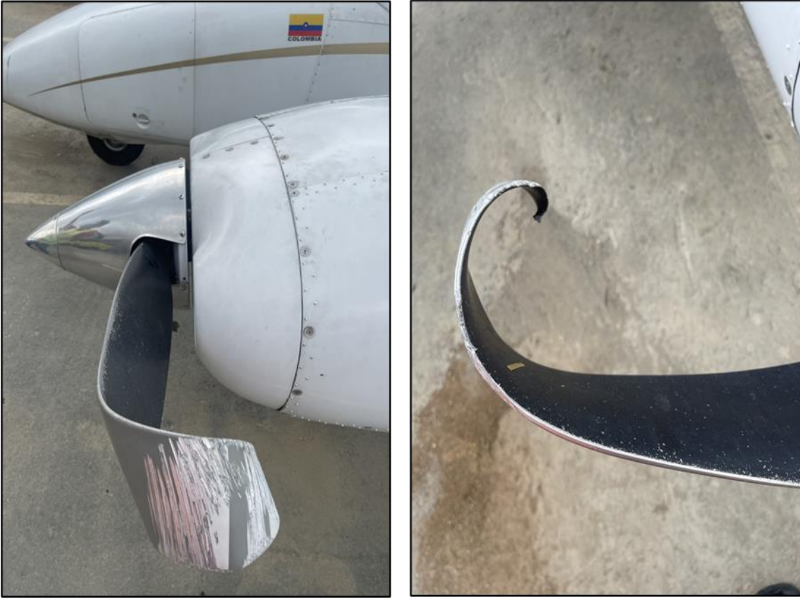
Fotografías No. 4 y 5 - Daños causados a las hélices
