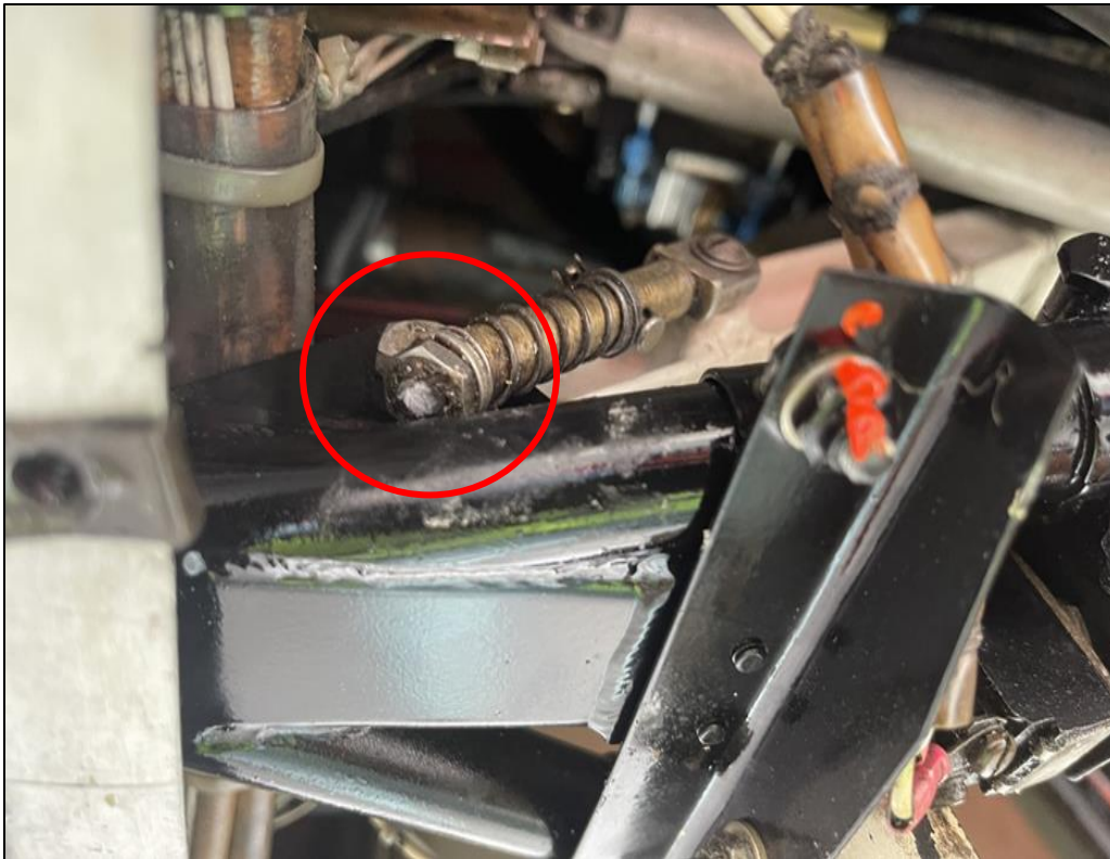
Fotografía No. 8 - Posición y condición en la que se encontró el seguro del tren delantero
