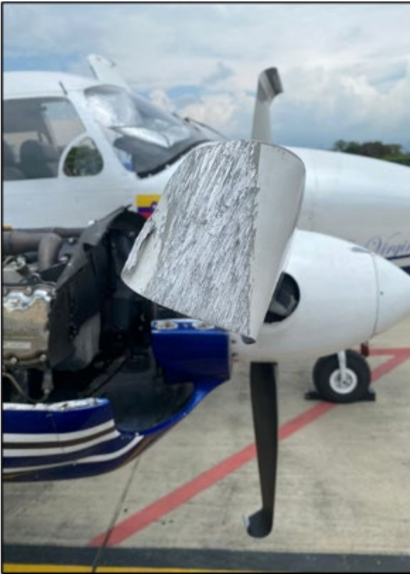
Fotografías No. 6 y 7: golpes en las palas del motor izquierdo y roce en la parte inferior de la aeronave.
