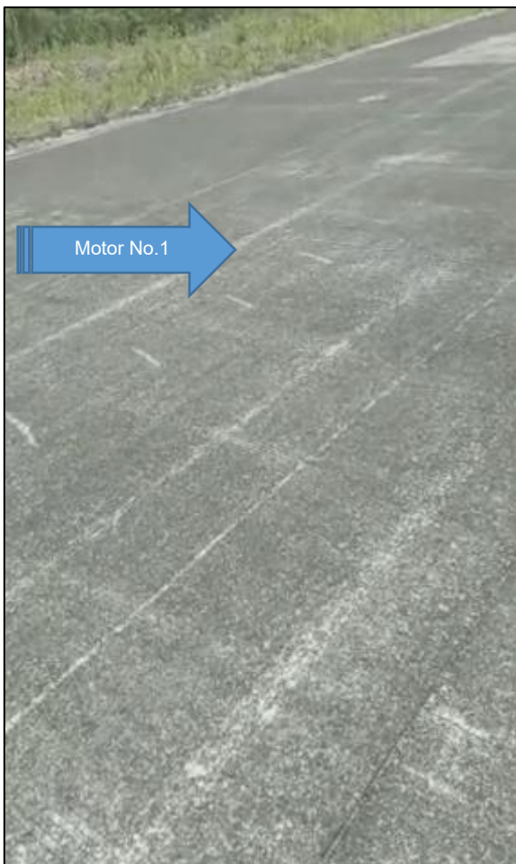
Fotografías No. 4 y 5: Huellas de las palas de las hélices de los motores en la pista.
