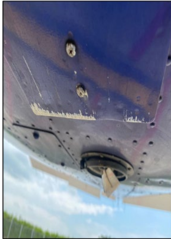
Fotografías No. 6 y 7: golpes en las palas del motor izquierdo y roce en la parte inferior de la aeronave.
