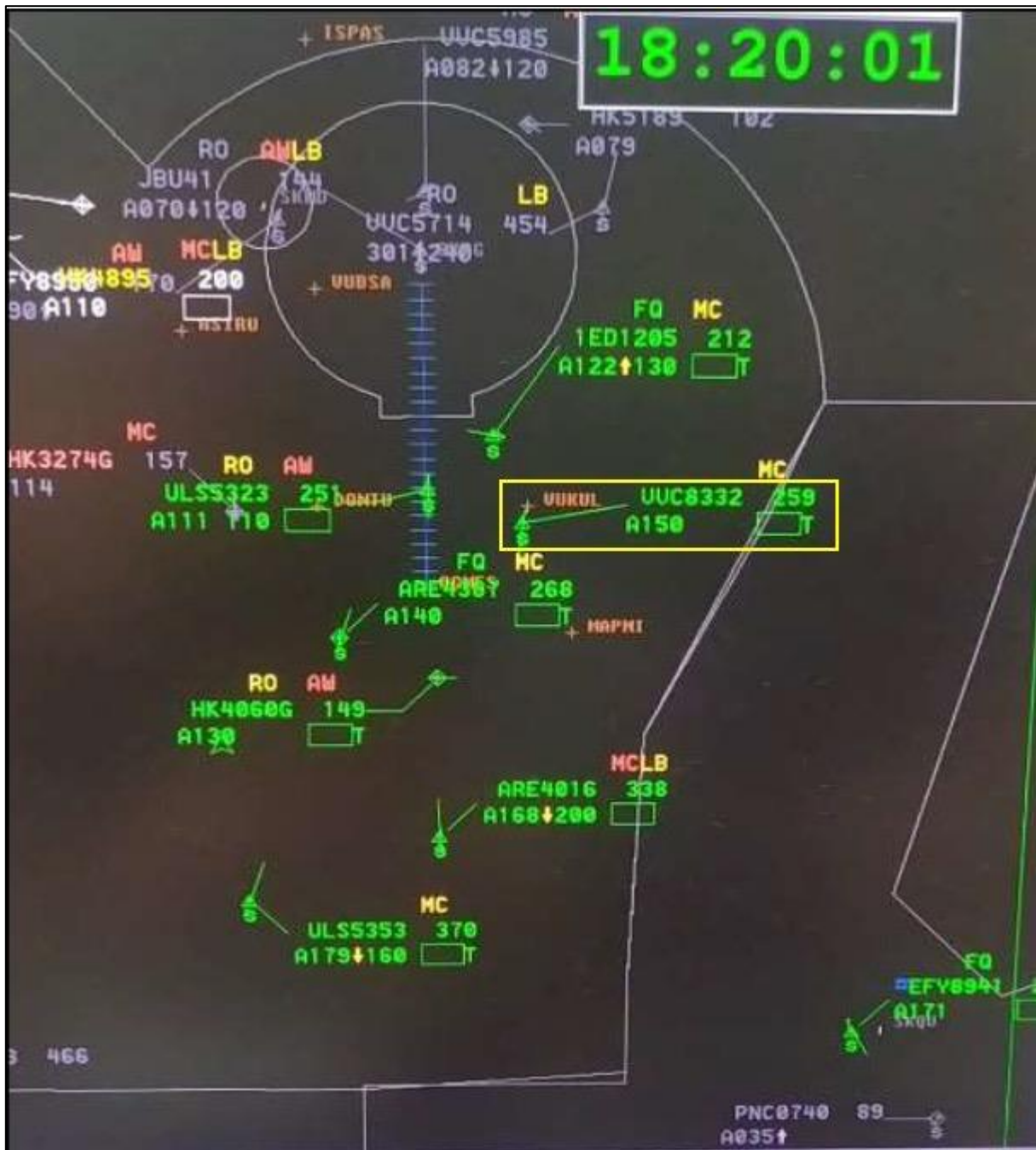
Imagen No. 9: Situación Radar – aeronaves en esperas; vuelo 8332 en VUKUL a 15.000 ft
