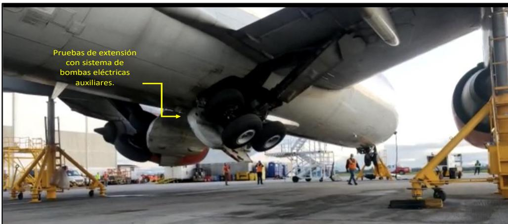
Fotografía No. 9 – Pruebas en los sistemas de retracción con sistemas auxiliares.
