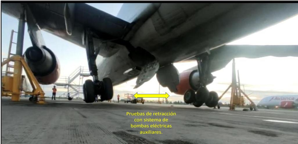
Fotografía No. 8 – Pruebas en los sistemas de extensión con sistemas auxiliares .
