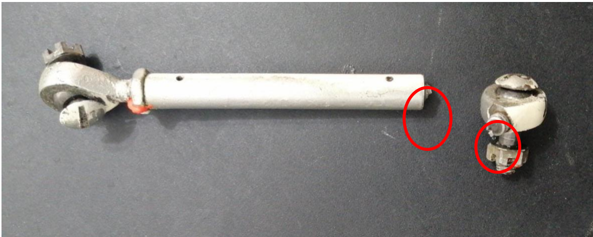
Fotografía No. 4 - Seguro del tren izquierdo que se fracturó
