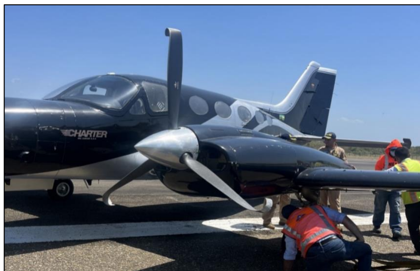
Fotografía No. 2 – Daños en la hélice del motor izquierdo.
