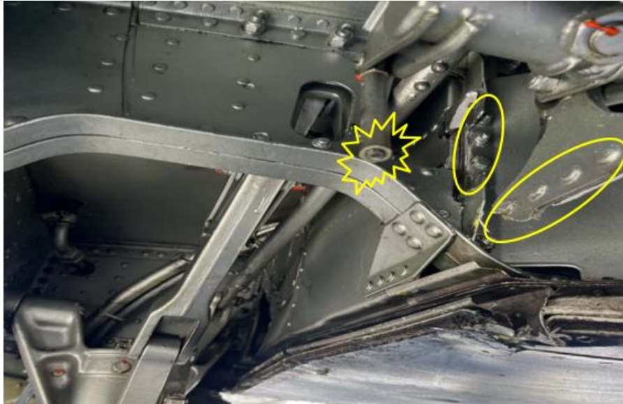
Fotografía No. 6 - Posición y condición en la que se encontró el seguro del tren izquierdo
