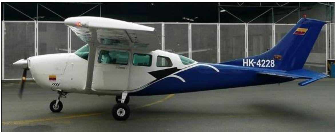
Imagen No. 1 - Configuración triciclo de la aeronave Cessna C206
