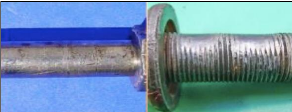
Fotografía No. 13: Daños por ludimientos en la rosca del perno.
