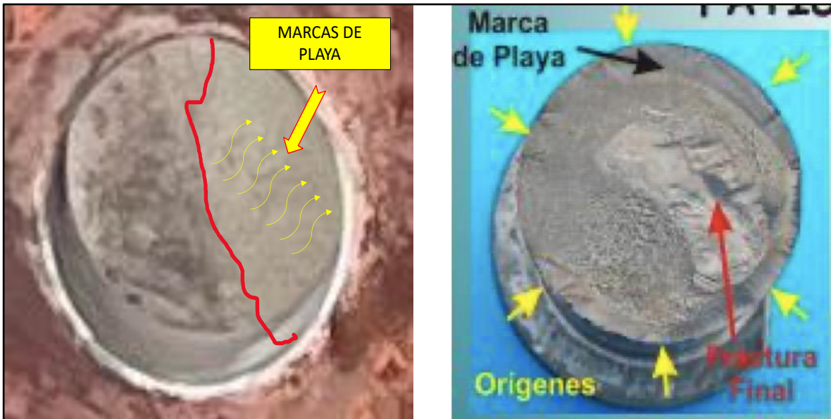
Fotografía No. 8: Fatiga por tensión.
