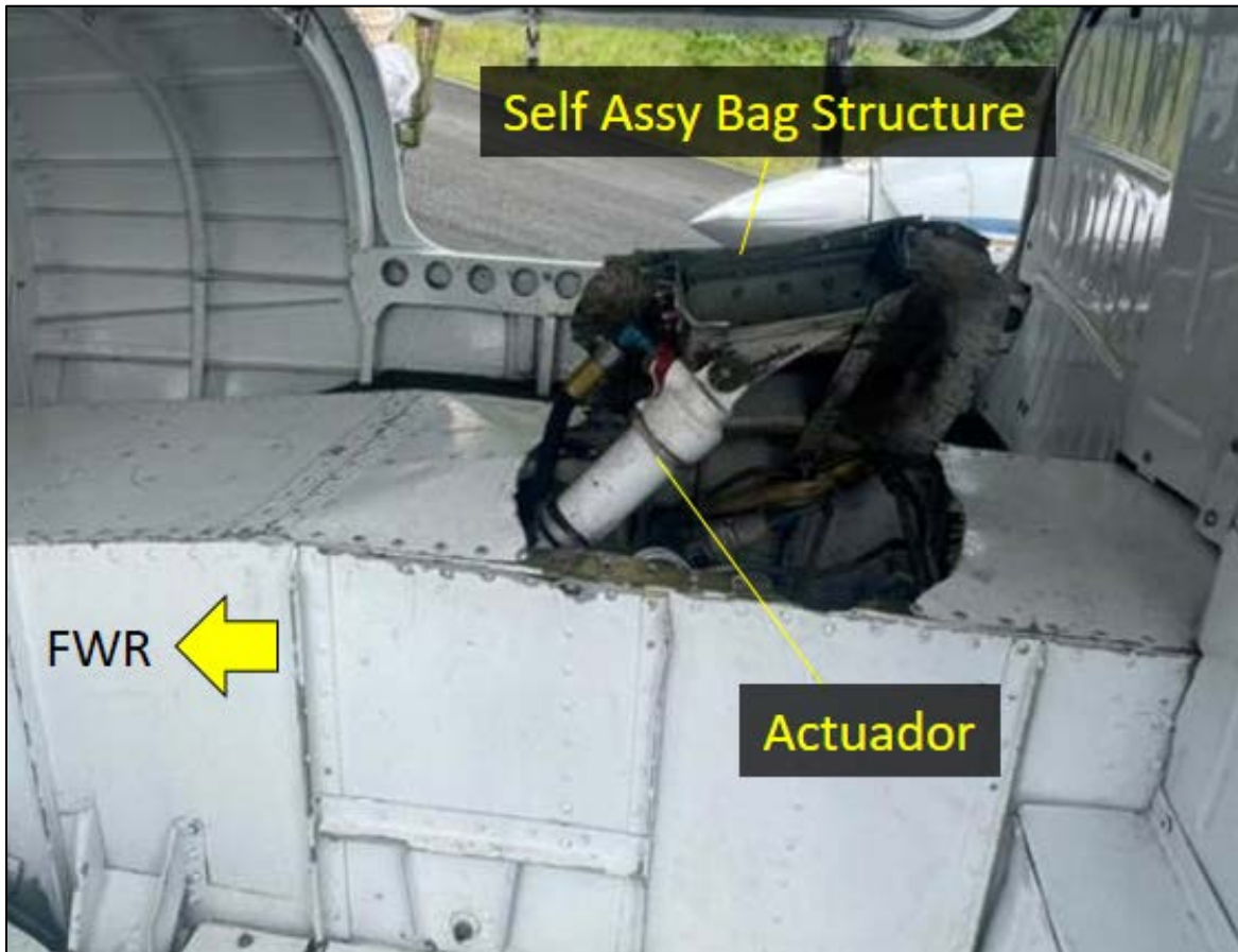
Fotografía No. 2 - Condición interior del compartimiento de carga frontal aeronave HK3065
