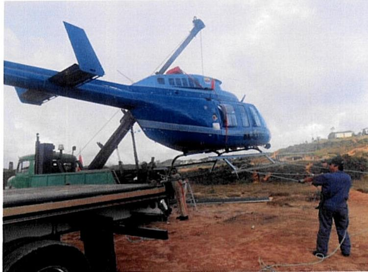
Foto 1.7 Procedimiento de colocación del helicóptero en el camión para su transporte terrestre.
