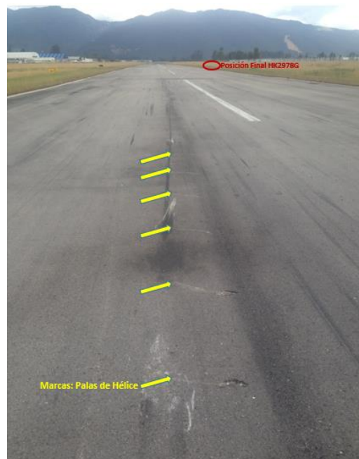
Marcas sobre la superficie asfáltica dejadas por las puntas palas de la hélice
