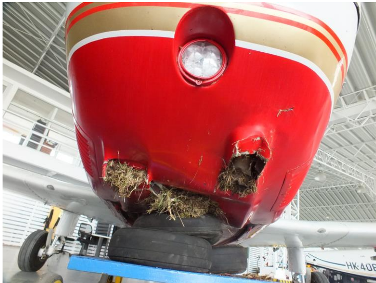
Daños en la cubierta inferior del motor a causa del rozamiento con la superficie asfáltica
