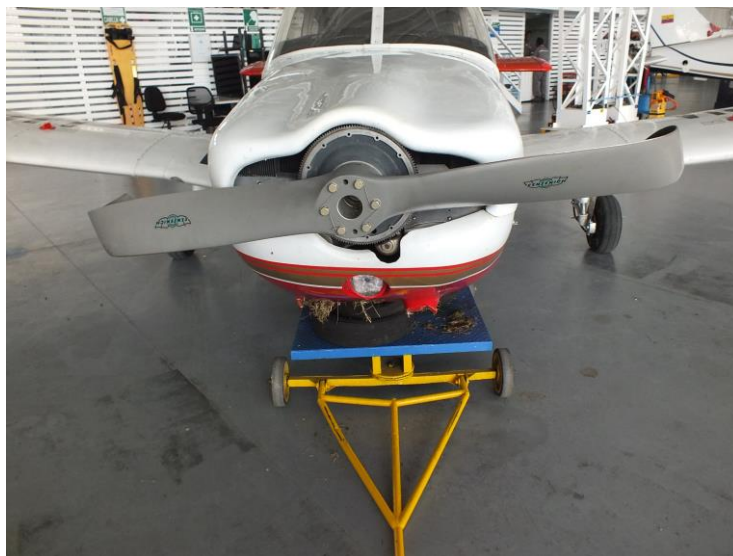
Deformación puntas palas de la hélice
