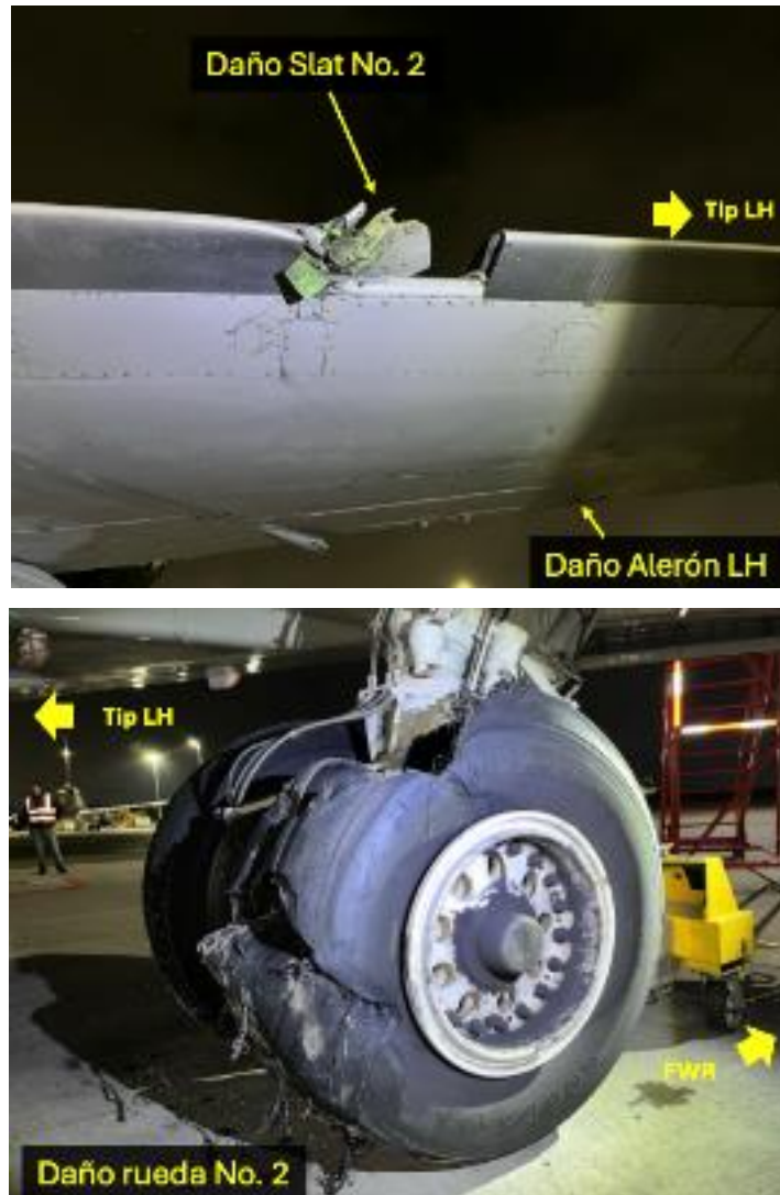
Imágenes No. 3 y 4 – Localización de daños en aeronave HK5216.
