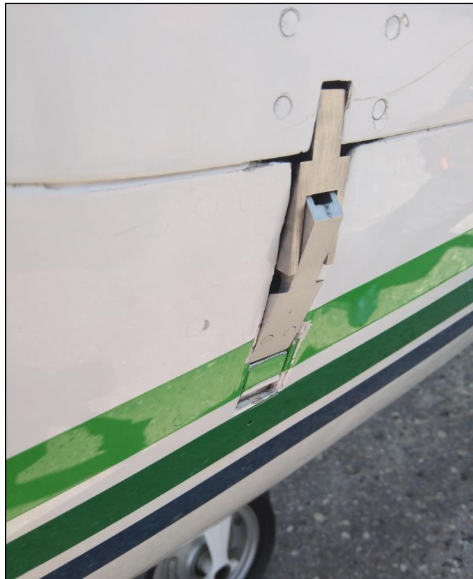
Figura 9. Detalle del seguro trasero de la puerta derecha de la bodega de carga durante las pruebas de funcionamiento (en posición parcialmente desasegurado).
