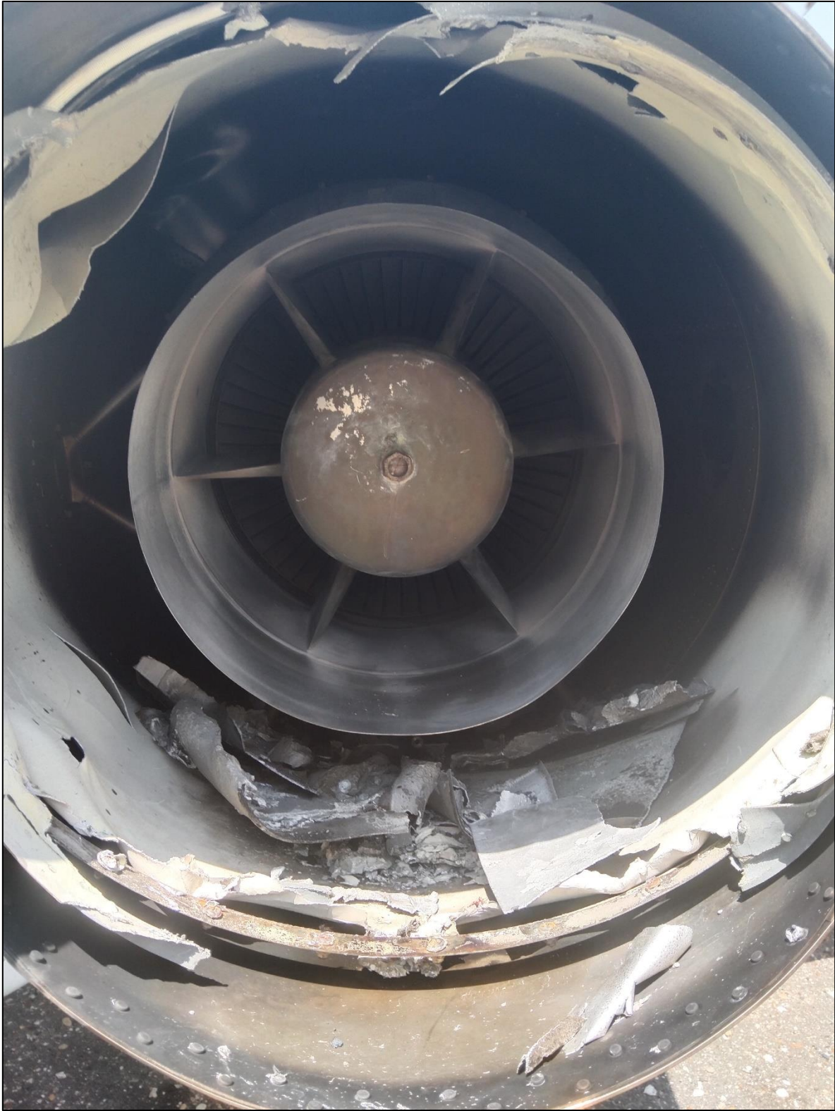
Figura 8. Daños en la parte posterior de la turbina derecha.
