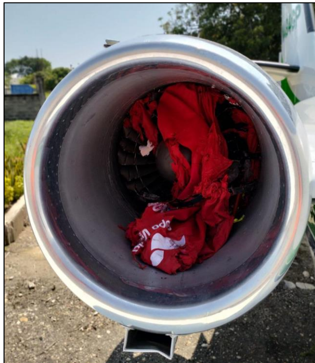
Figura 7. Objetos foráneos FOD en la entrada del motor derecho.
