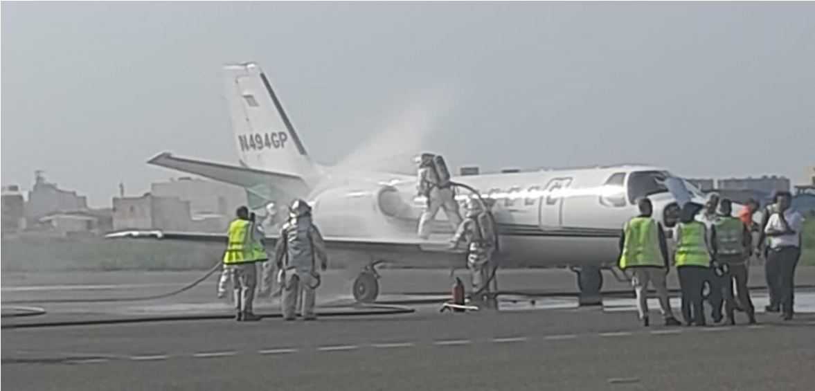
Figura 5. SEI aplicando agua en la turbina derecha. Fuente: Grupo Aeroportuario del Caribe.
