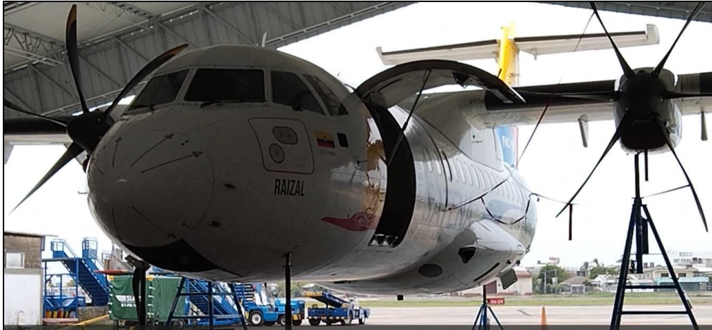
Figura 6. Pruebas de extensión y retracción del tren de aterrizaje posterior al evento.
