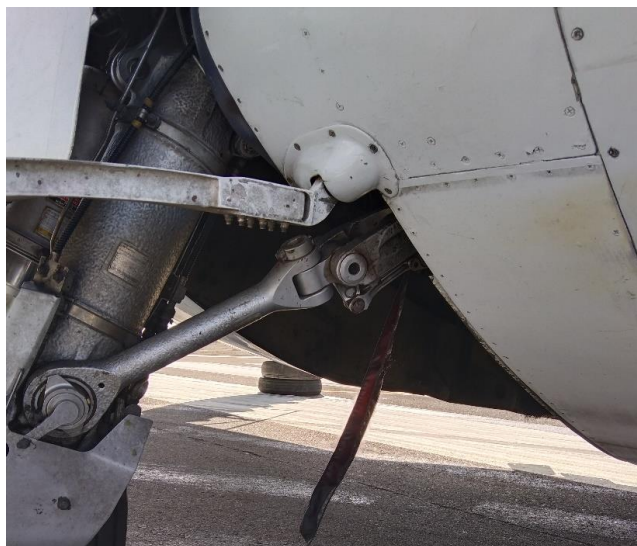
Figura 4. Pasador de seguridad instalado en el RMLG.
