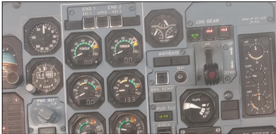
Figura 3. Luces de tren desasegurado en cabina de pilotos al momento del evento.
