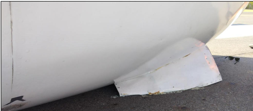
Figura 2. Daños a las compuertas del tren de nariz
