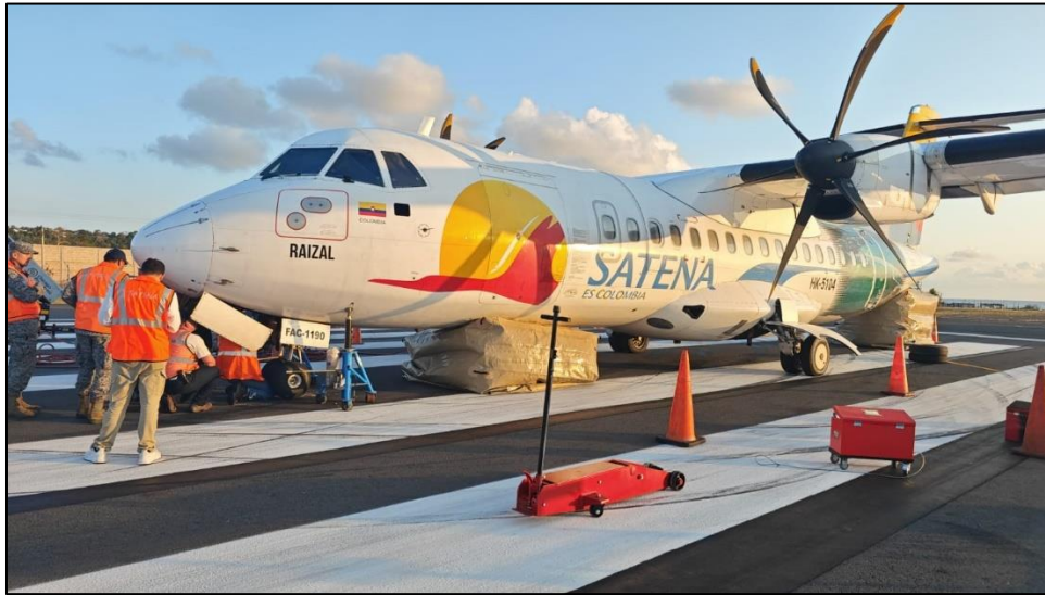
Figura 5. Recuperación de la aeronave y extensión del tren de nariz.
