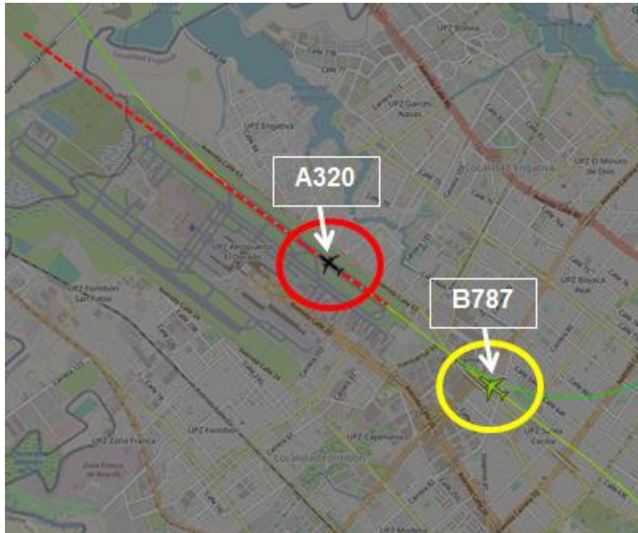
Gráfica No. 1: Vista de A320 despegando en Pista 32R y B787 en final corta.
