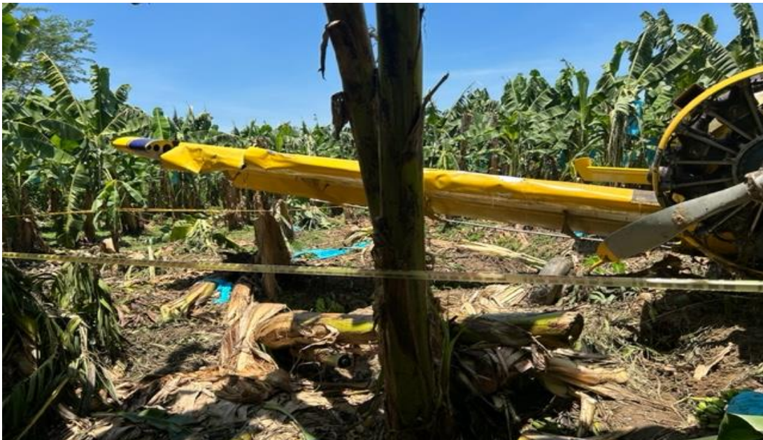
Fotografía No. 3: Daños en el borde del plano derecho de la aeronave.
