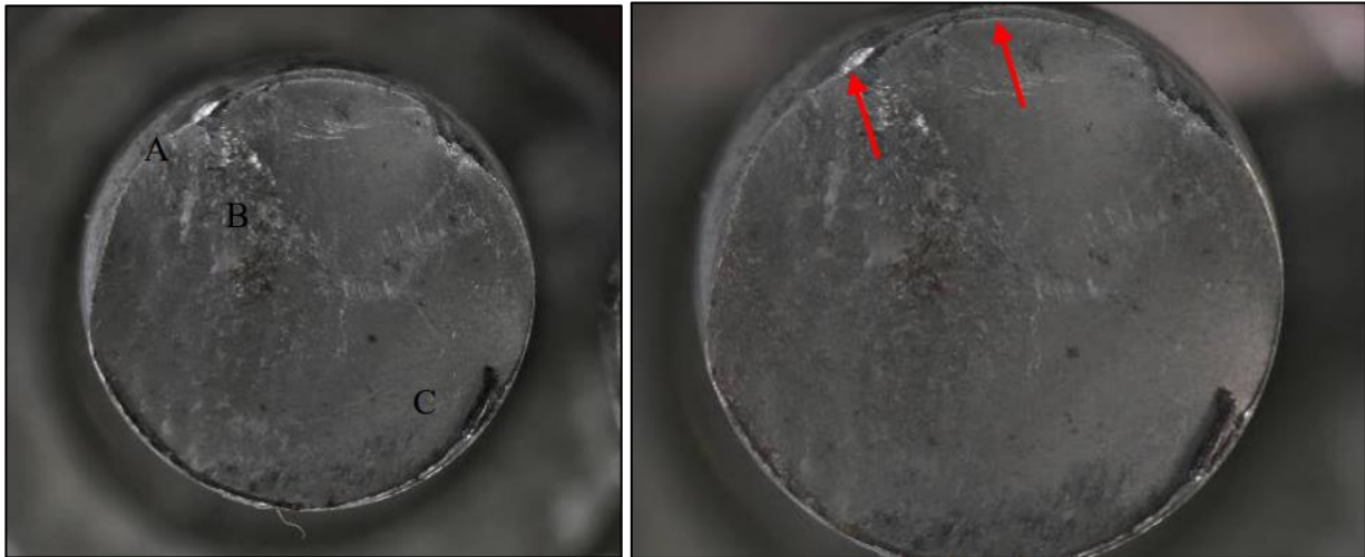
Imágenes No. 5 y 6: Muestra tuerca cabeza. Las flechas indican el inicio de la fractura. A) Zona inicio de fractura. B) zona de propagación. C) Zona de deformación plástica fractura.
