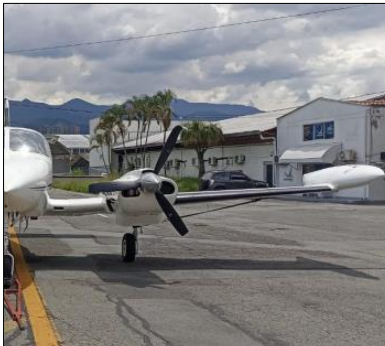
Fotografías No. 2 y 3: Daños en las palas de la hélice del motor izquierdo.
