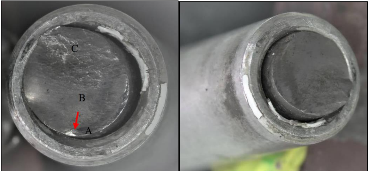
Imágenes No. 15 y 16: Muestra fractura tuerca. Las flechas muestran el inicio de la fractura. A) Zona inicio de fractura. B) zona de propagación. C) Zona de deformación plástica fractura final.
