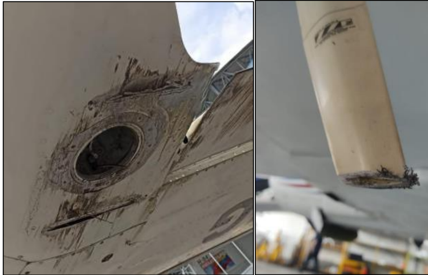
Fotografías No. 7 y 8: Izquierda, raspaduras y desprendimiento de piel del plano izquierdo. Derecha, fractura de la antena.
