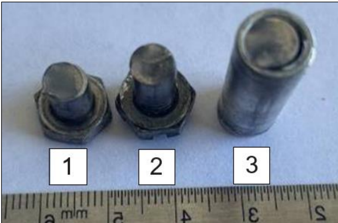
Fotografía No. 13. 1) Muestra fractura cabeza. 2) Muestra fractura tuerca. 3) Muestra fractura buje.
