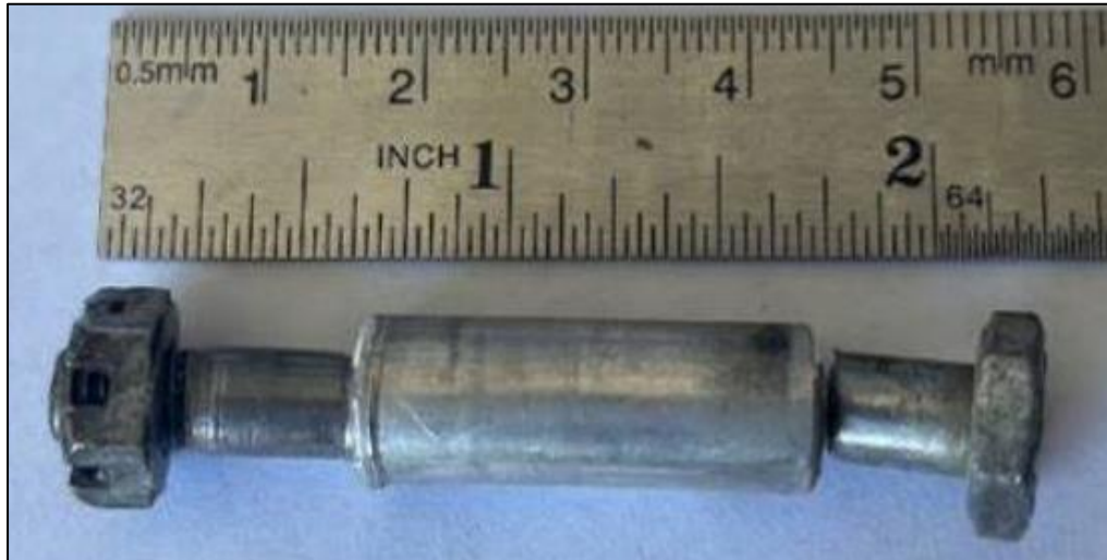
Fotografía No. 10: Pivot Bolt (S/N: NAS464P4-26), perno fracturado objeto de análisis.
