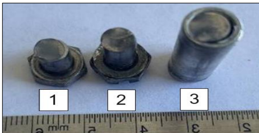
Fotografía No. 9: Fractura en tres partes del perno de pivote.
