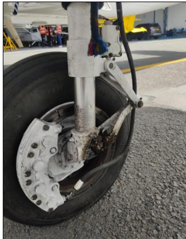
Fotografías No. 5 y 6: Izquierda, fractura palanca de acople (bellcrank assy). Derecha, raspaduras en el conjunto de enlace de torque y pistón.
