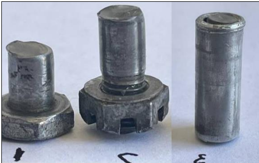
Fotografía No. 14. 1) Muestra fractura cabeza. 2) Muestra fractura tuerca. 3) Muestra fractura buje
