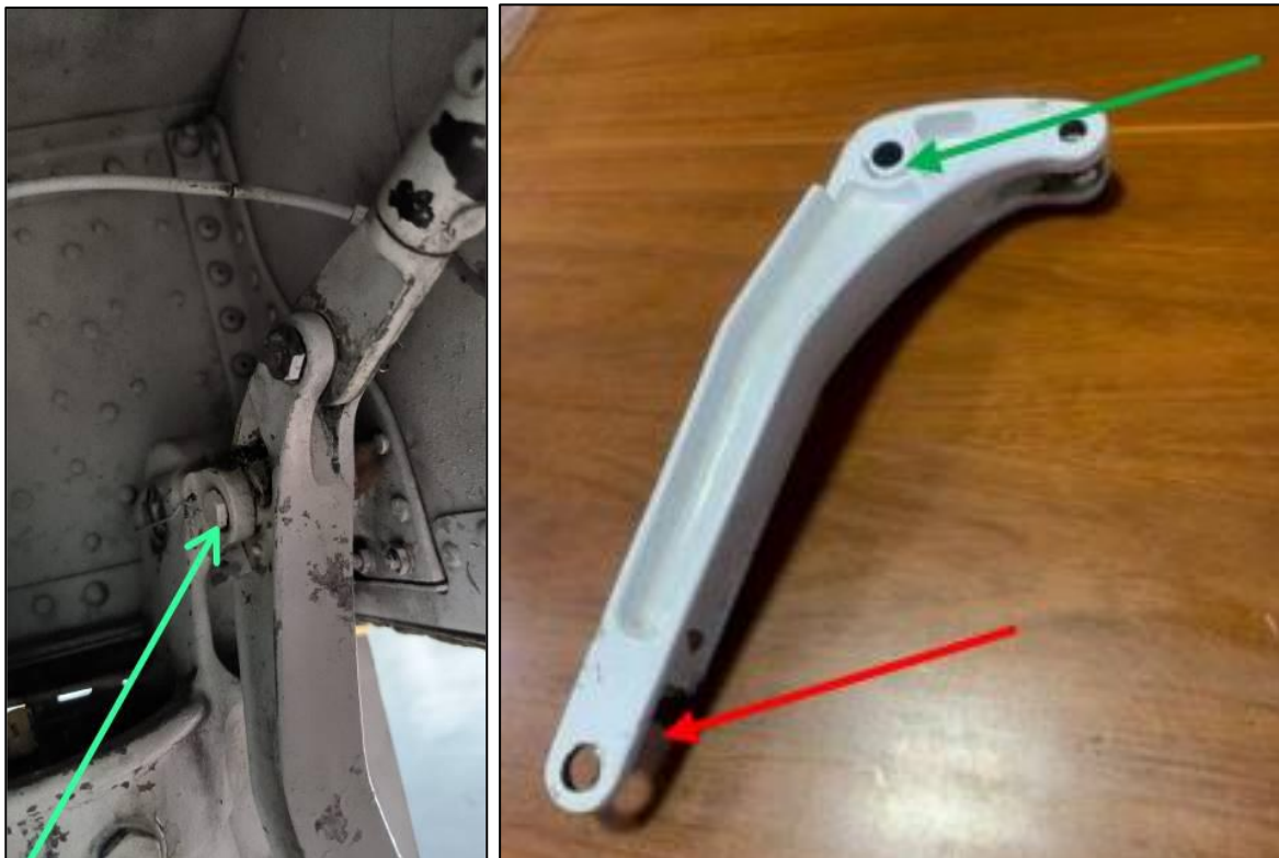
Fotografías No. 11 y 12: Flecha verde la ubicación del perno en el ensamble del tren de aterrizaje. Flecha roja, pestaña de la horquilla fracturada producto del desajuste del tren, posterior a la fractura del perno.
