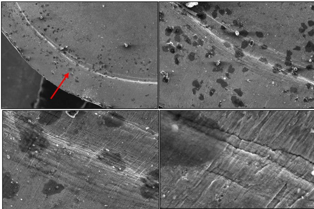
Imágenes No. 19, 20, 21 y 22: La flecha indica la zona de fatiga y la zona de acercamiento con el microscopio para observar estrías de deformación del avance de la grieta hacia el centro del perno.
