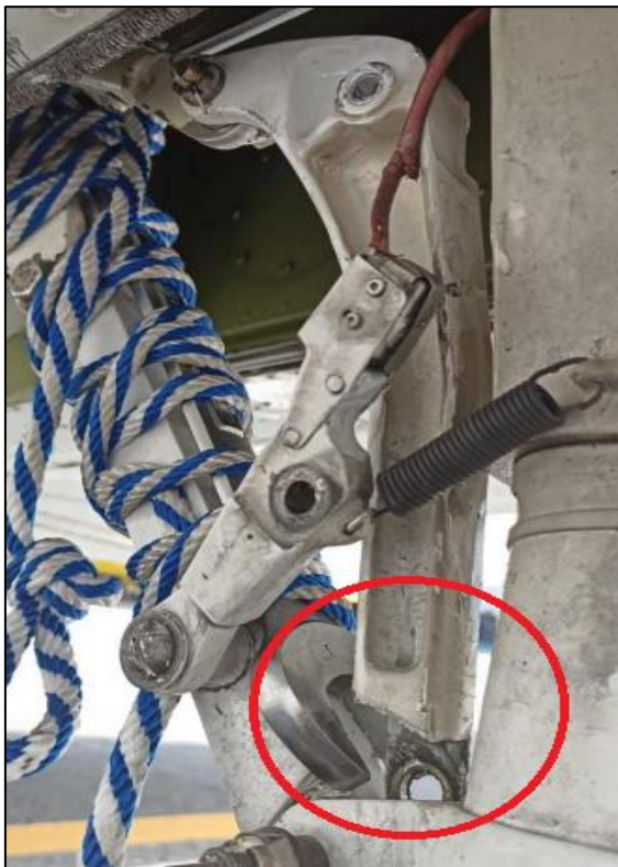
Fotografías No. 5 y 6: Izquierda, fractura palanca de acople (bellcrank assy). Derecha, raspaduras en el conjunto de enlace de torque y pistón.
