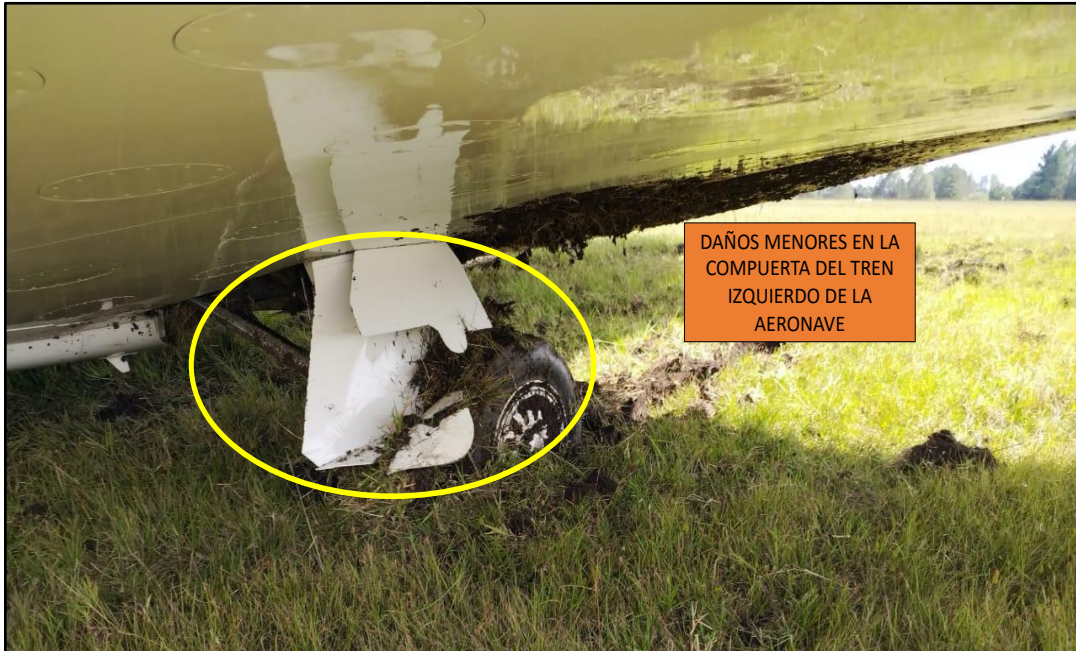
Fotografía No. 2: Daños en la compuerta del tren izquierdo.
