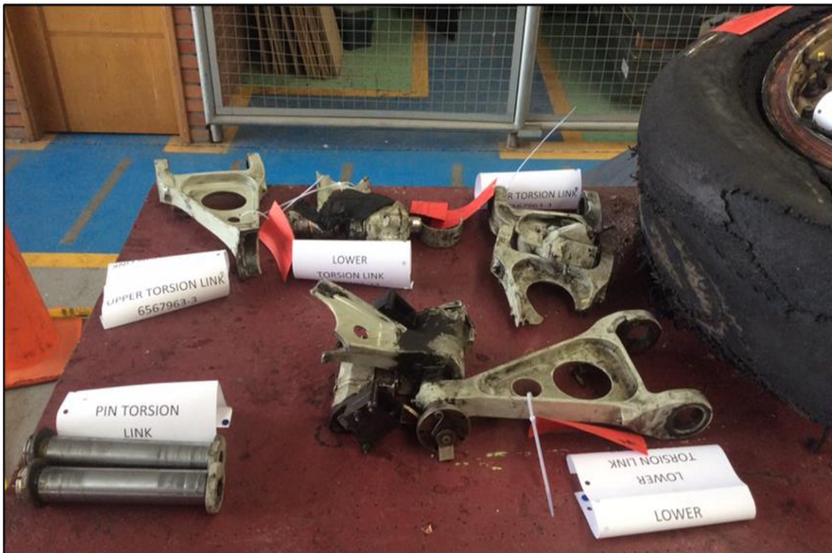
Fotografía No. 3 – ruptura del Lower Torsión Link del tren principal, posterior a falla del “Shimmy Damper”
