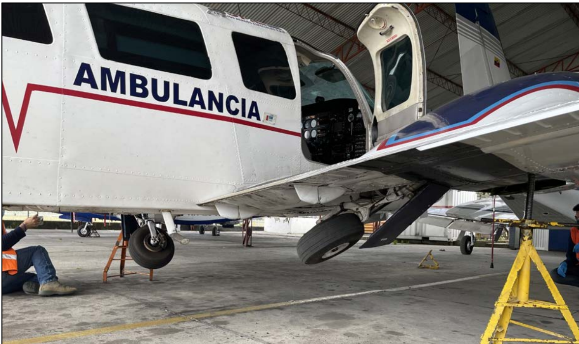
Fotografía No. 03 – Pruebas efectuadas al tren de aterrizaje del HK2713.
