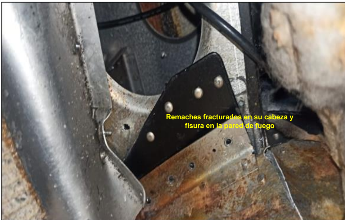
Fotografía No. 4 - Refuerzo del tren de delantero y remaches fracturados.
