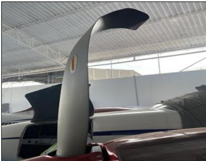
Fotografía No. 3 - Daños causados en las hélices.
