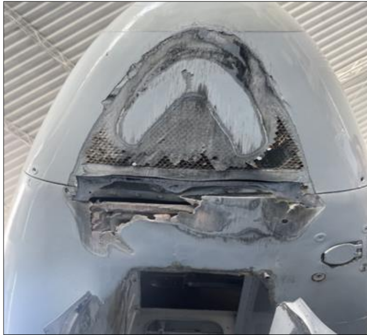
Fotografía No. 2 - Daños presentados en el morro de la aeronave.
