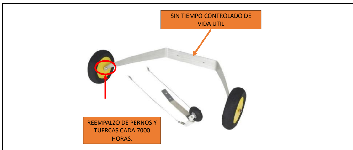
Imagen No. 14. identificación de partes tren de aterrizaje.
