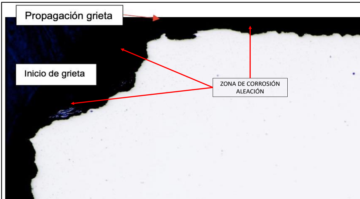
Fotografía No. 13. Picados corrosivos en el punto de inicio y en las vecindades.
