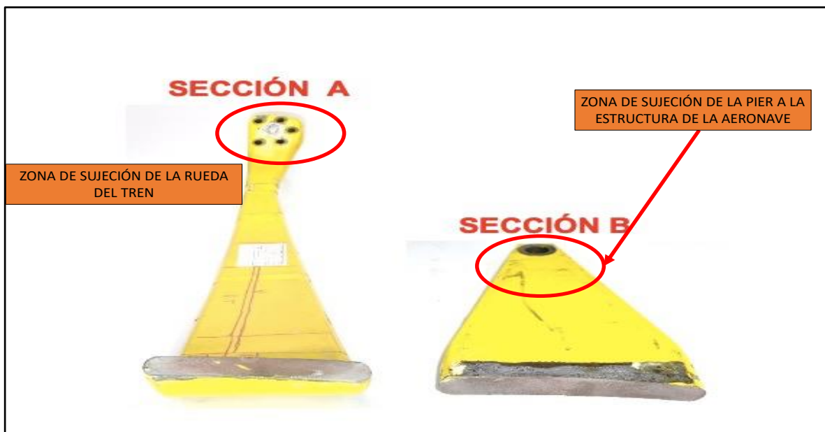
Fotografía No. 3. Tren principal izquierdo avión AC-05 Pijao.
