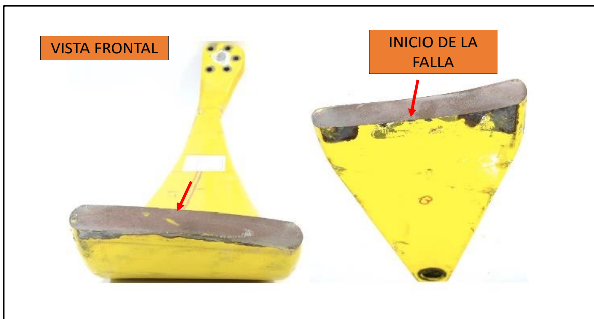
Fotografía No. 5. Vista frontal, identificación inicio de falla.
