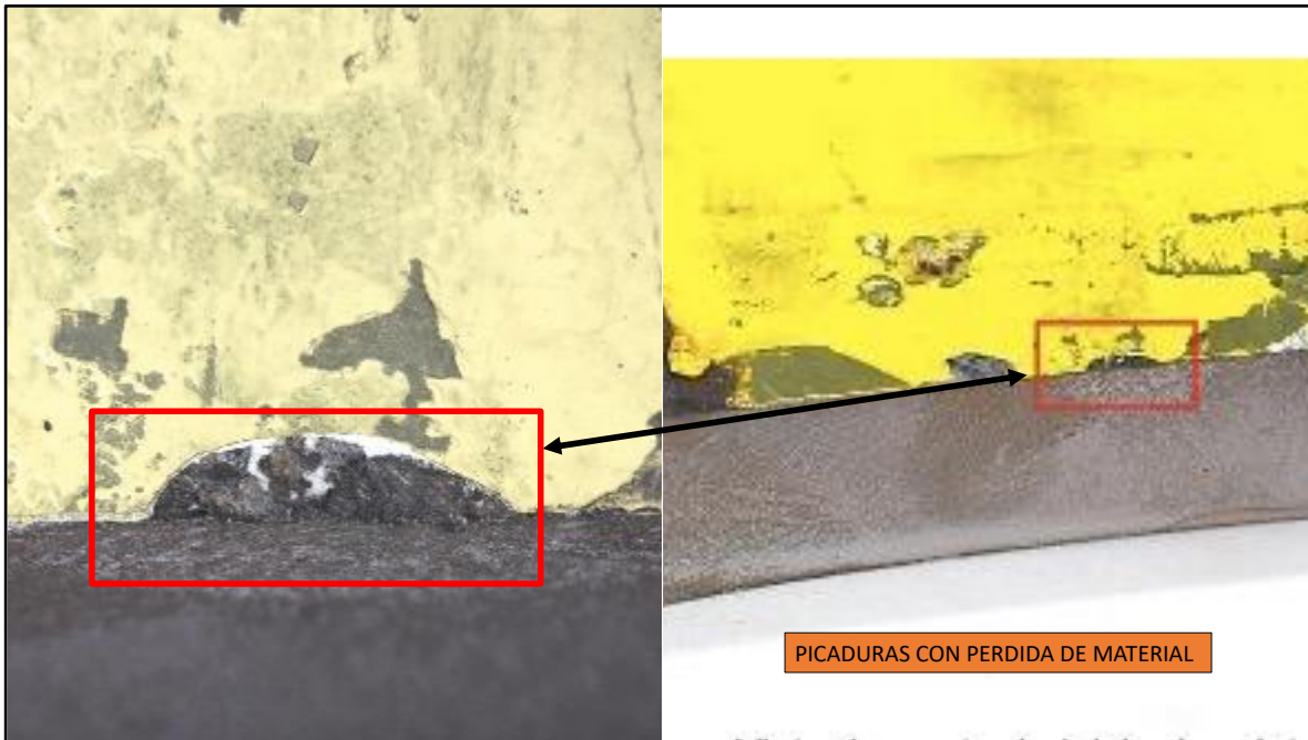
Fotografía No. 6. Inicio de falla con picadura en el material.
