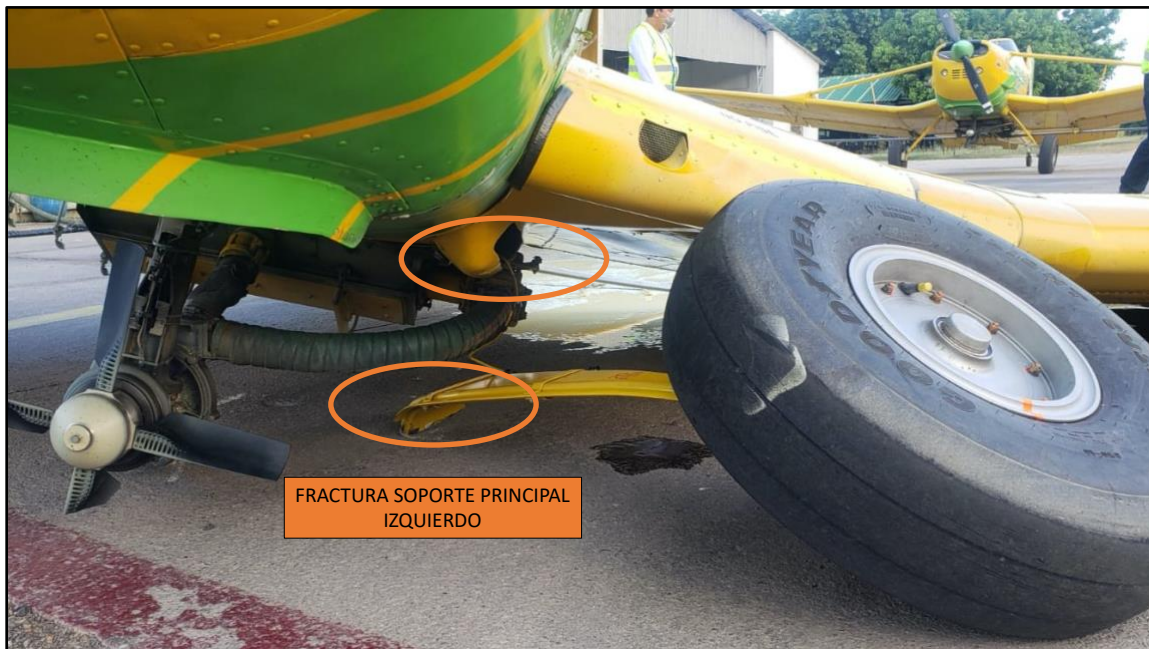
Fotografía No. 2. Fractura pierna tren principal izquierdo.
