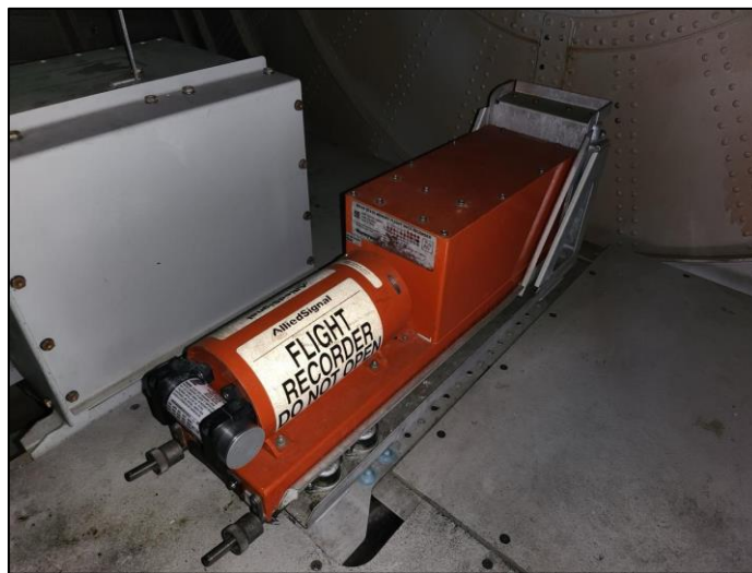
Fotografía No. 1 – Registrador de datos de vuelo FDR aeronave HB-JMD
