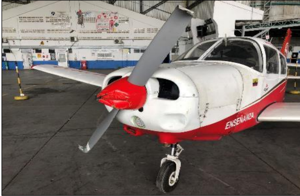
Fotografía 6: Daños en la hélice, spinner y parte frontal del capó.
