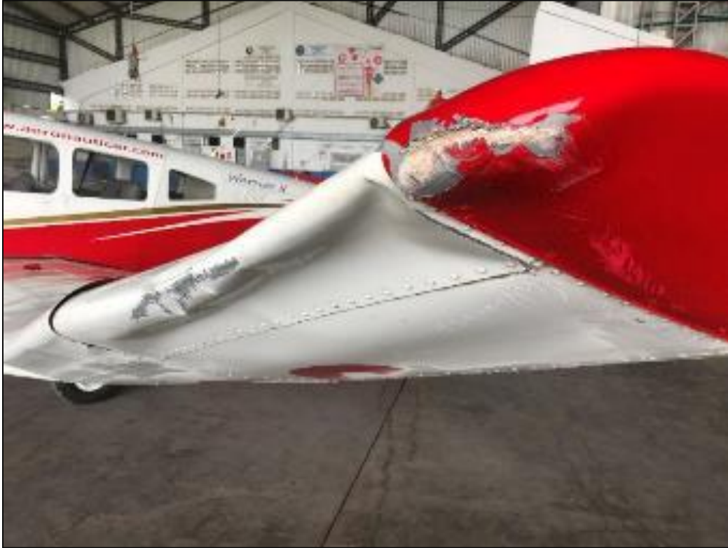
Fotografía 4: Daños en el plano izquierdo del HK-4998G
