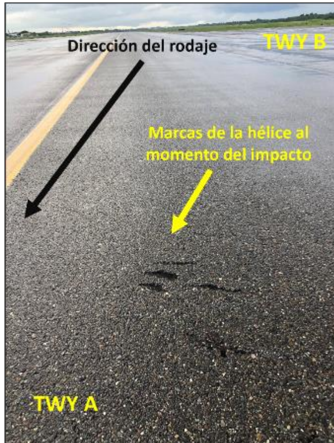
Fotografía 3: Marcas del contacto de la hélice contra la superficie.
