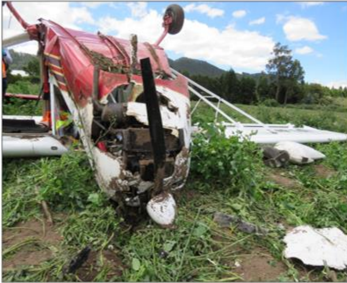
Fotografía No. 4: Izquierda- estado final de la hélice. Derecha- afectaciones del motor y su cubierta.
