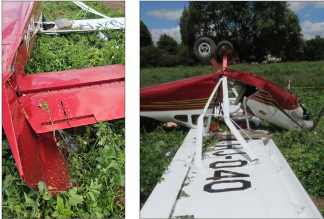
Fotografía No. 3: Izquierda- deformación del estabilizador vertical. Derecha- asimetría del soporte del tren principal.
