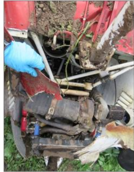
Fotografía No. 4: Izquierda- estado final de la hélice. Derecha- afectaciones del motor y su cubierta.
