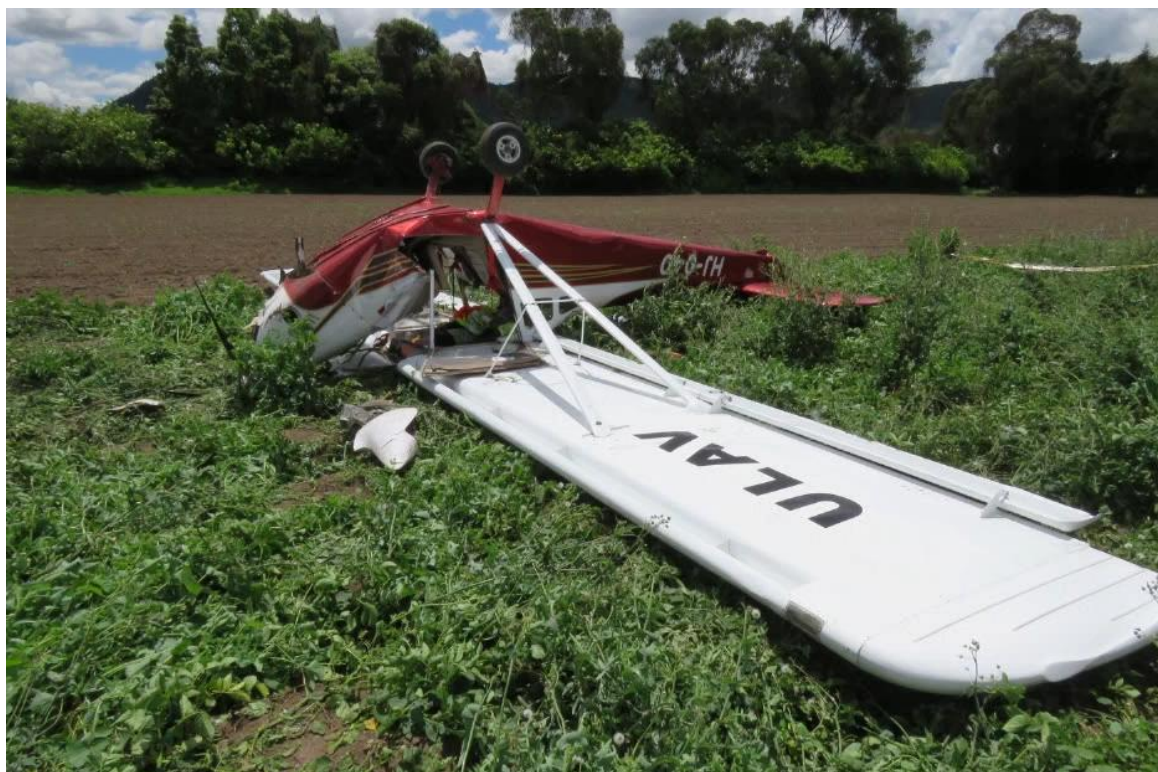
Fotografía No. 2: Deformación estructural del fuselaje de la aeronave HJ 040.
