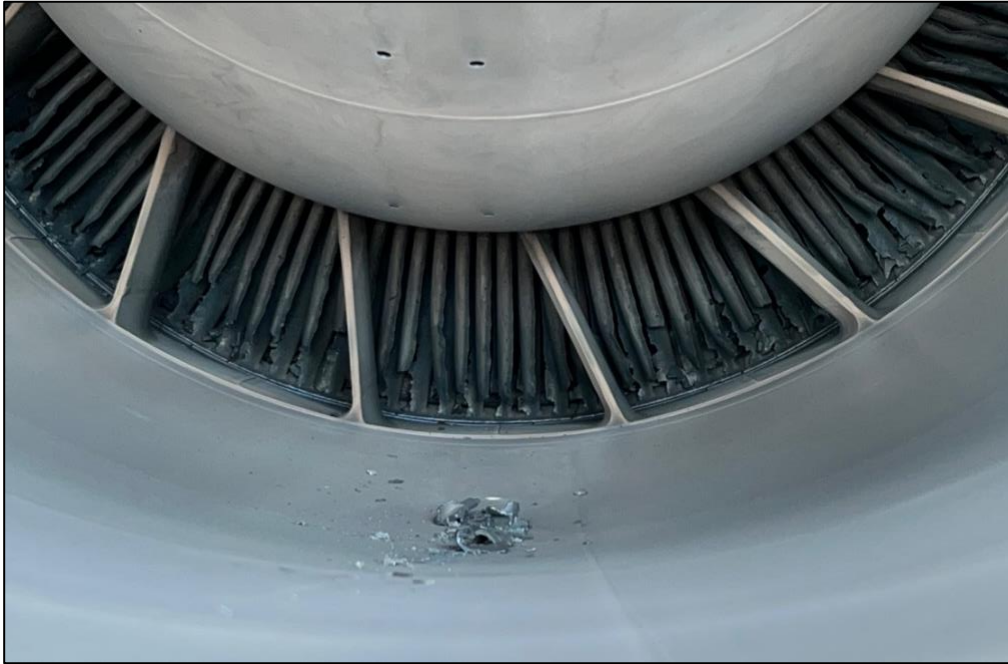
Fotografía No. 3: Apariencia general y restos de los álabes de etapa de turbina de baja presión LPT, del motor No. 2.
