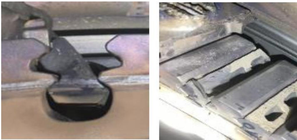
Fotografías No. 5 y 6: Localización de la junta del álabe “min-neck” en HPT. Fuente: CFM International.
