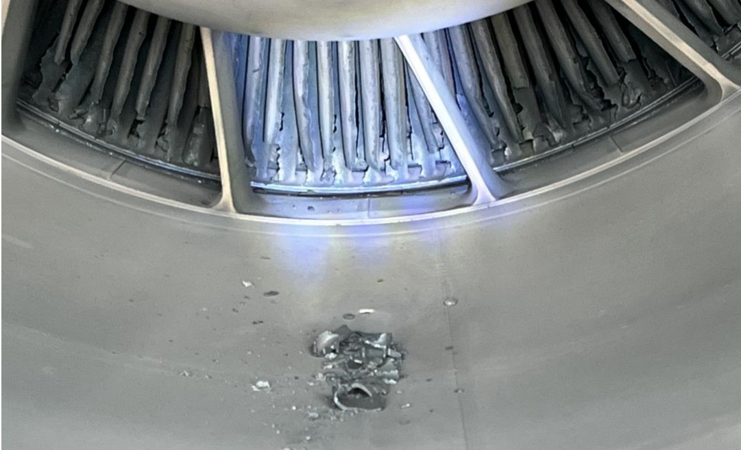
Fotografía No. 4: Condición de los álabes y restos en la sección LPT, motor SN 645640.
